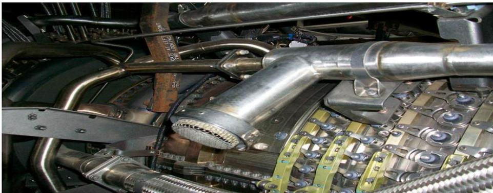
**Figure III.15 :** Mélange de l'air du package avec air du 9ème étage par le venturimètre pour la pressurisation du puisard
