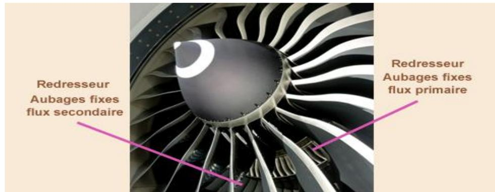
**Figure III 2:** La soufflante du turboréacteur GE 90
