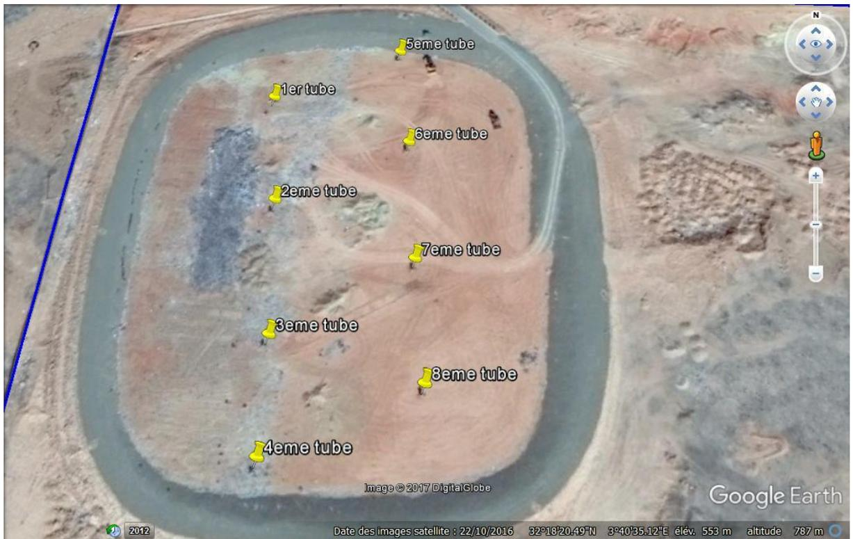
**Images N° 12 : 8 point de tube de sortie biogaz.**
