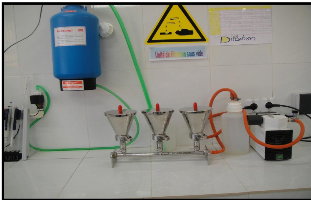
Photo 4.4 unité de filtration avec une pompe à vide
