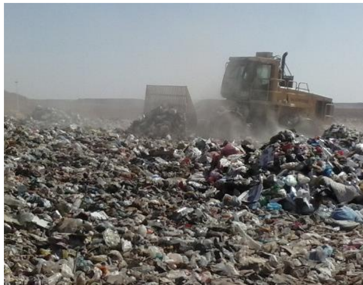
Photo 10 : Compacteur pied de mouton (CET- v. M'Zab).
