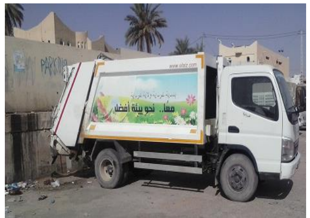
Photo 2 : Camion benne tasseuse (Ghardaïa).
