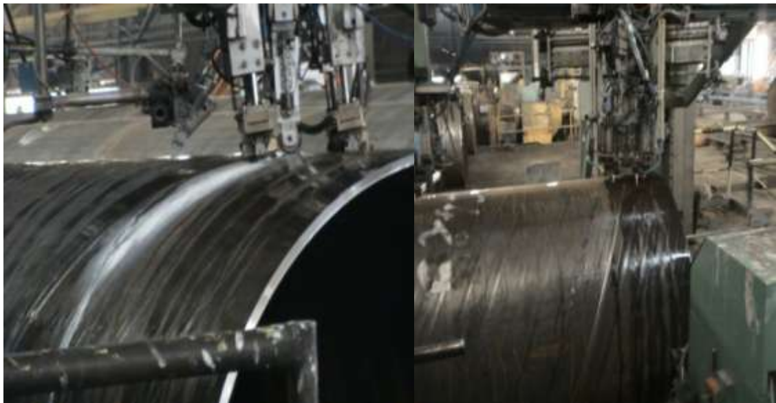
Figure I.7 : Tube à l'examen ultrasons
