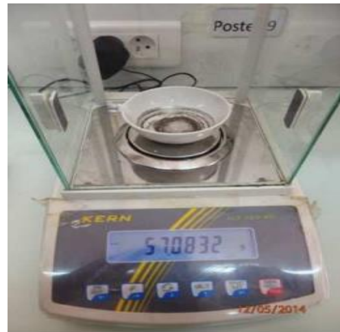
photo(5): Creuset en platine contenant les Résidus sec.
