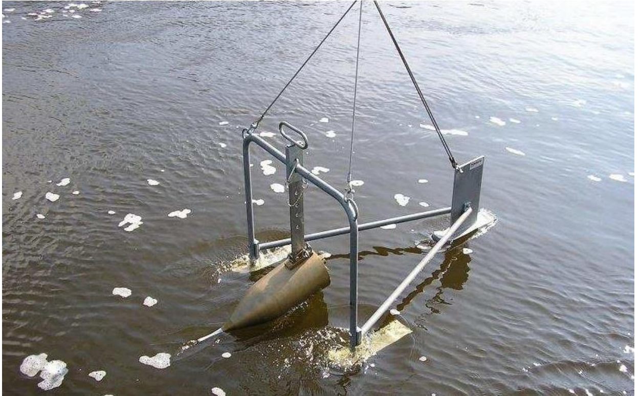
Figure09 : un piégeage des sédiments dans l'appareil de mesure
