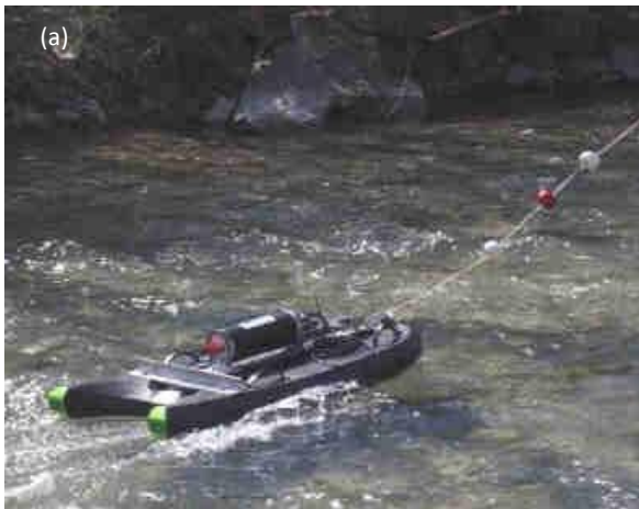
Figure 07 : (a) Radeau dérivant équipé d'un hydrophone ; (b) Exemple de profil acoustique obtenu
