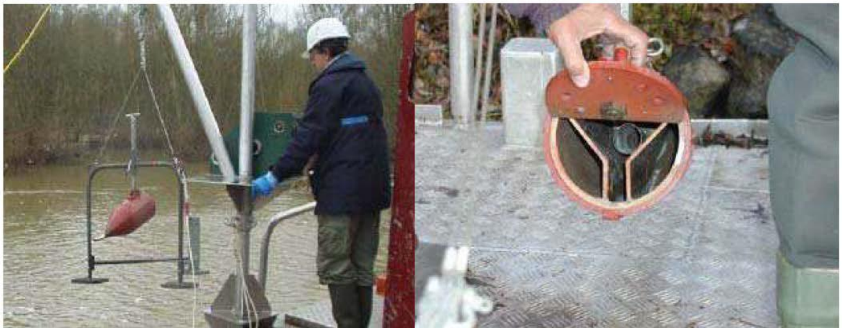
Figure 05 : Appareil de mesure de la charge en suspension (Mussy2002).
