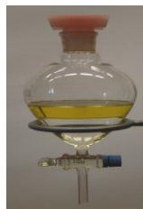
Figure II.8 : La décantation d'une émulsion d'eau et d'huile
