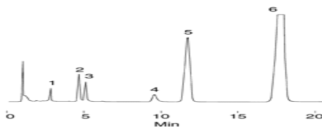
Figure V.11: Chromatogramme obtenu par HPLC liquide-solide ( phase normale )
