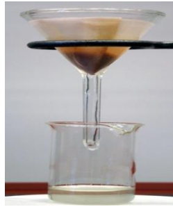
Figure II.3 : schéma de la filtration d'une suspension de sable dans l'eau
