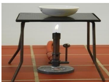
Figure III.3: l'évaporation de l'eau salée pour récupérer le sel dissous.
