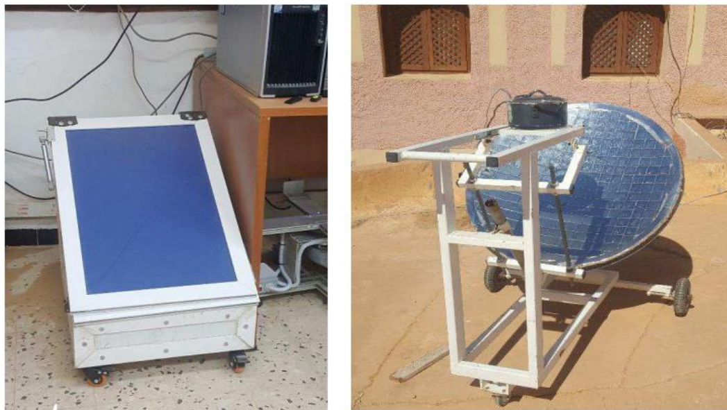
Figure I. 1 : Deux prototypes de cuiseurs solaires réalisés et testés à l'URAER Ghardaïa. [18]
