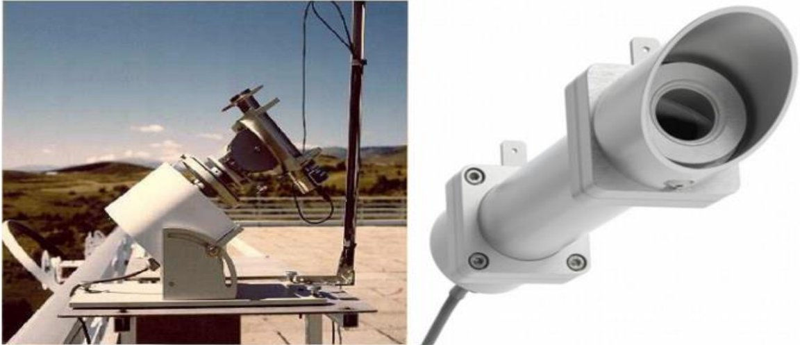
Figure II. 5 : Pyrhéliomètre pour la mesure de l'éclairement direct normal.
