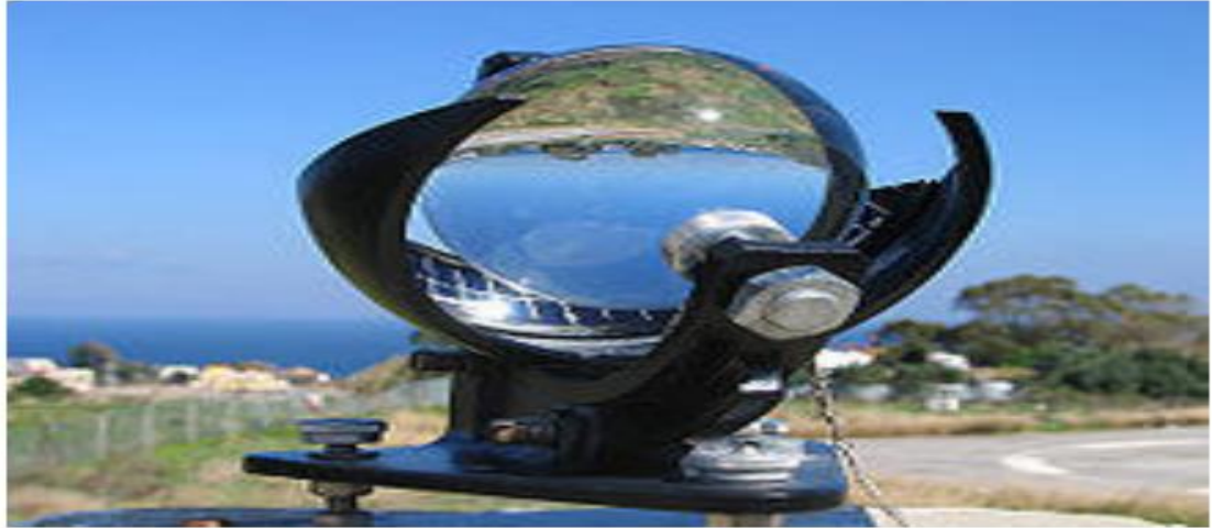
Figure II. 8 : Héliographe pour la mesure de l'insolation.
