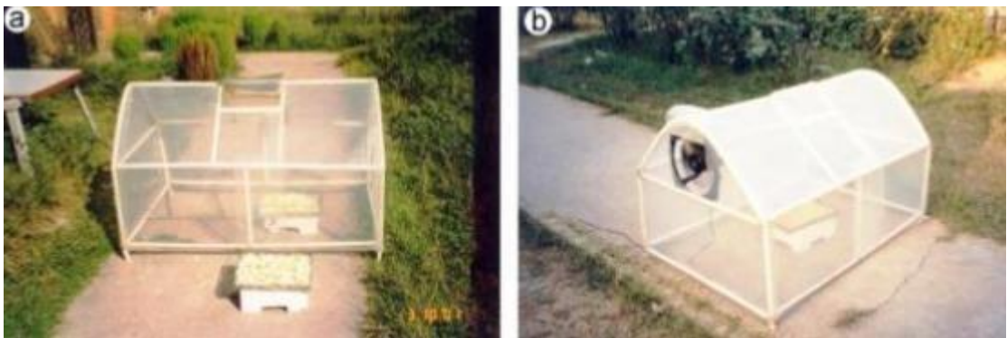
Figure II 5. Séchage sous serre (a) convection naturelle et (b) convection forcée
