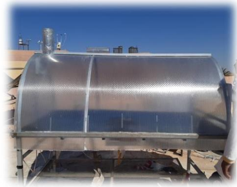
Fig. III.2. Prototypes de séchoir solaire de type direct en polycarbonate
