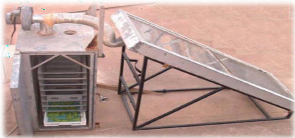
Fig. II.14. Séchoir solaire à convection forcée indirect [Mohamed et al. 2008].
