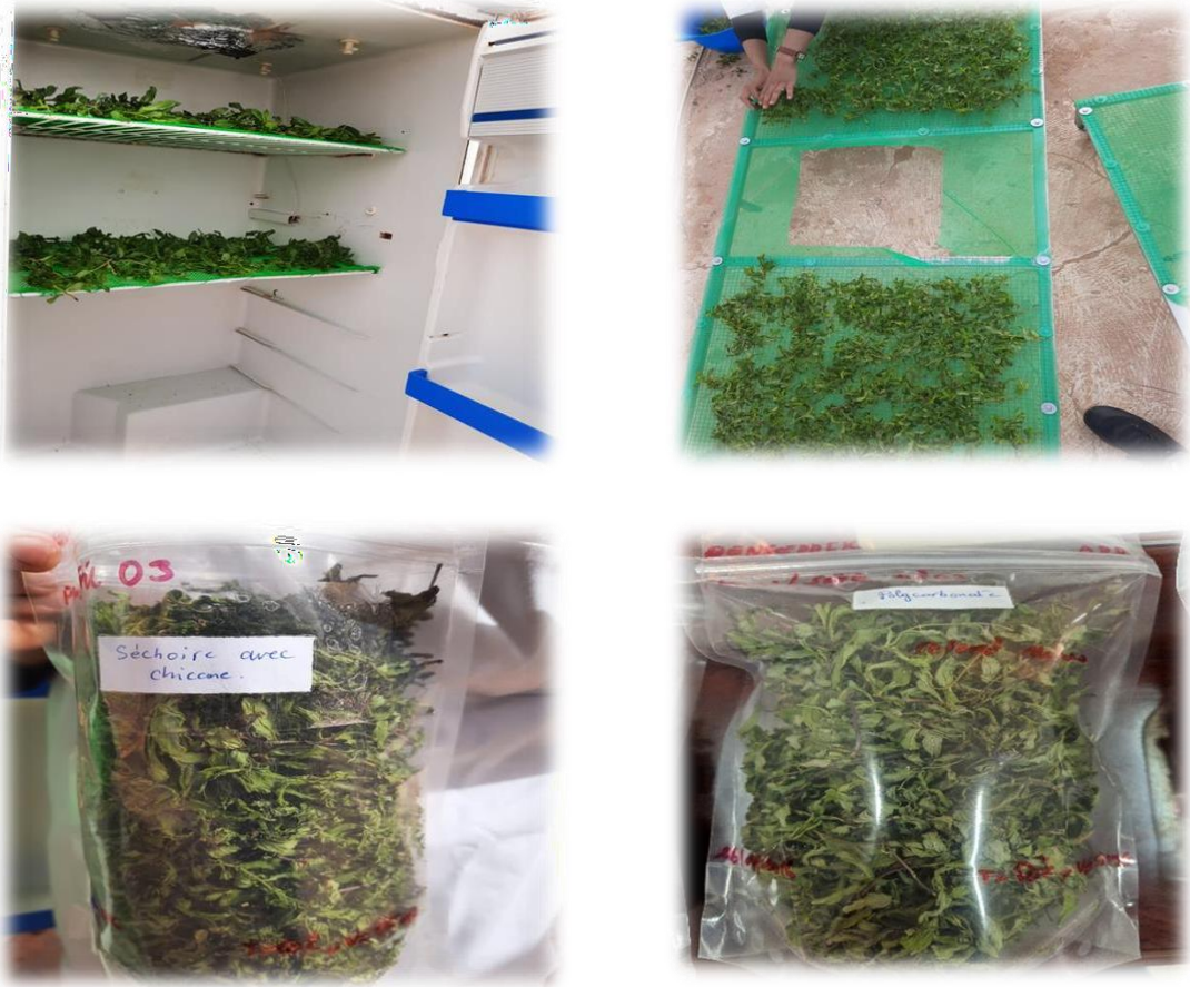
Fig. IV.6. Dispositions des échantillons de la menthe dans la chambre de séchage pour les séchoirs direct et indirect.
