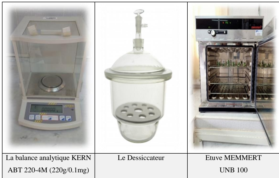
Fig. III.8. Matériels utilisés pour déterminer la teneur en eau initiale
