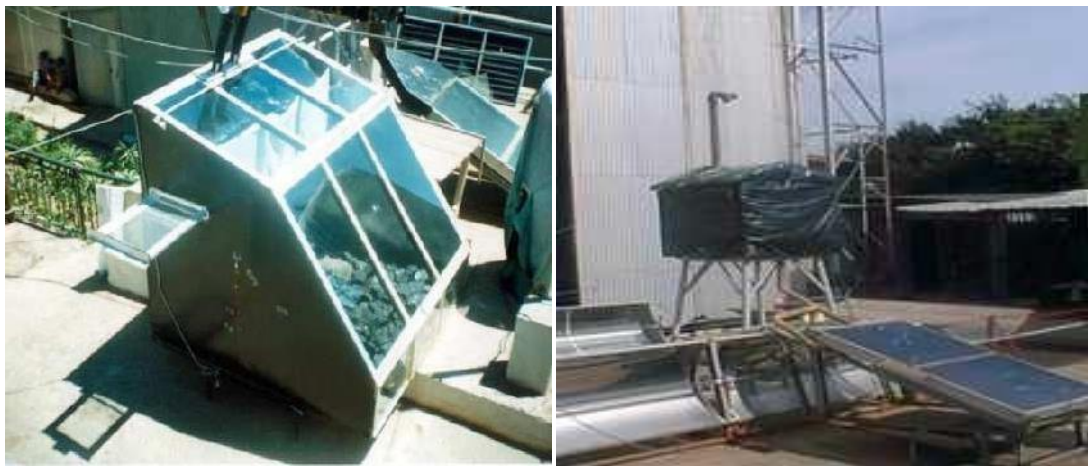
Séchoir solaire de type direct
