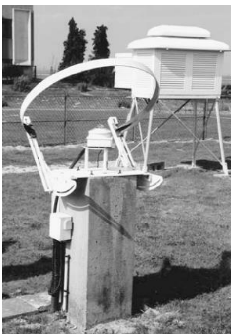
Figure II.2 : Pyranomètre équipé d'un pare-soleil : mesure du rayonnement diffus [3]
