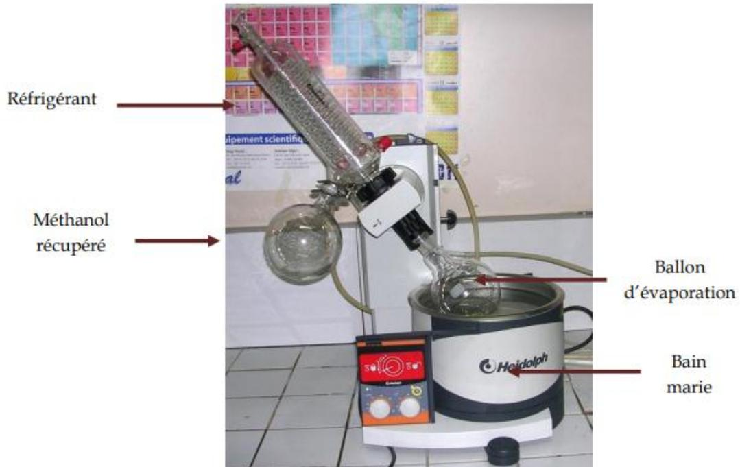
**Figure 08:** Evaporation à sec par le rotavapor.
