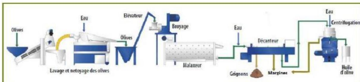
**Figure 09 :** Chaîne continue à trois phases pour l'extraction d'huile d'olive.
