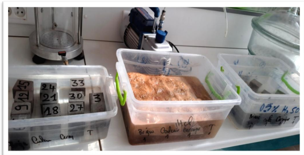
Figure (III.26) : Les Différentes bassins d'acide
