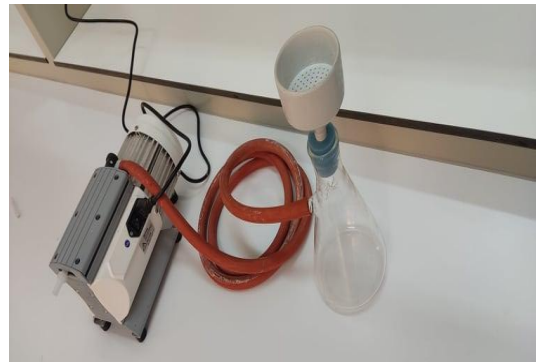
Photo 2 : pompe à vide.
