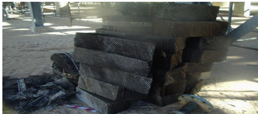
Figure II-9 : L'état du garnissage de la colonne
