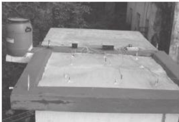
Fig.II.11 Toiture avec MC[74]
