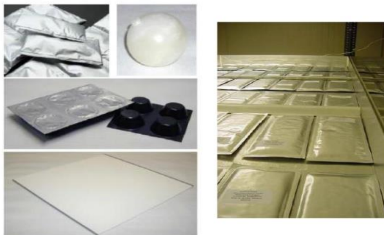
Fig.II.3 Illustration de MCP macro-encapsulés avec de l'aluminium, des capsules[30]
