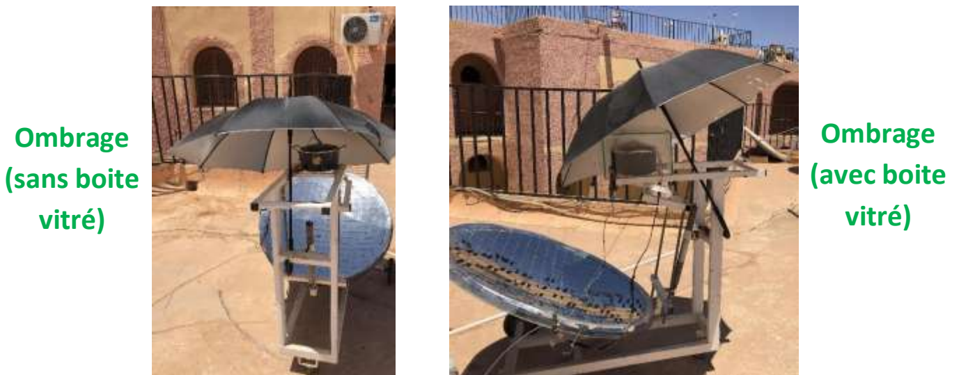
Figure III.13. Vue du cuiseur parabolique durant les tests de chauffage et refroidissement effectués sans et avec la boîte en verre.
