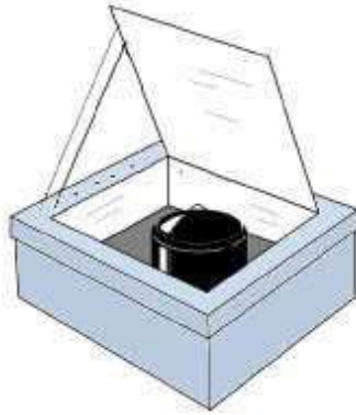
Figure II.7: Schéma de principe d'un cuiseur de type boîte [32].
