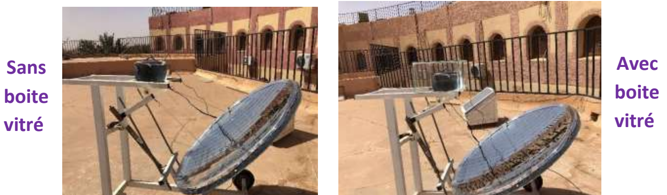
Figure III.9. Test montrant l'effet de la vitesse du vent (m/s) sur l'évolution des températures de l'eau (13 janvier 2022).
