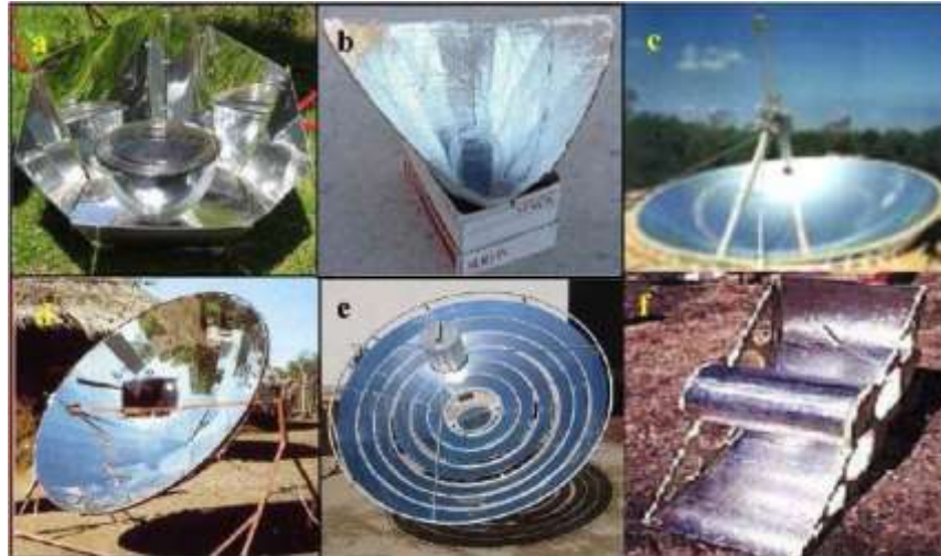
Figure II.12: Cuiseurs à concentration : (a) cuiseur a panneaux, (b) cuiseur entonnoir, (c) réflecteur sphérique, (d) réflecteur parabolique, (e) concentrateur Fresnel, et (f) concentrateur cylindro-parabolique.
