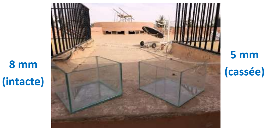
Figure III.19. Vue de la boite en verre utilisée de 8 mm (intacte) et de 5 mm (cassée).
