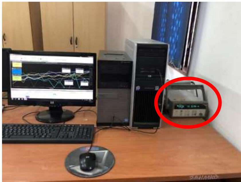
Figure III.4. Visualisation des températures sur un micro-ordinateur connecte à une unité d'acquisition de donnée.
