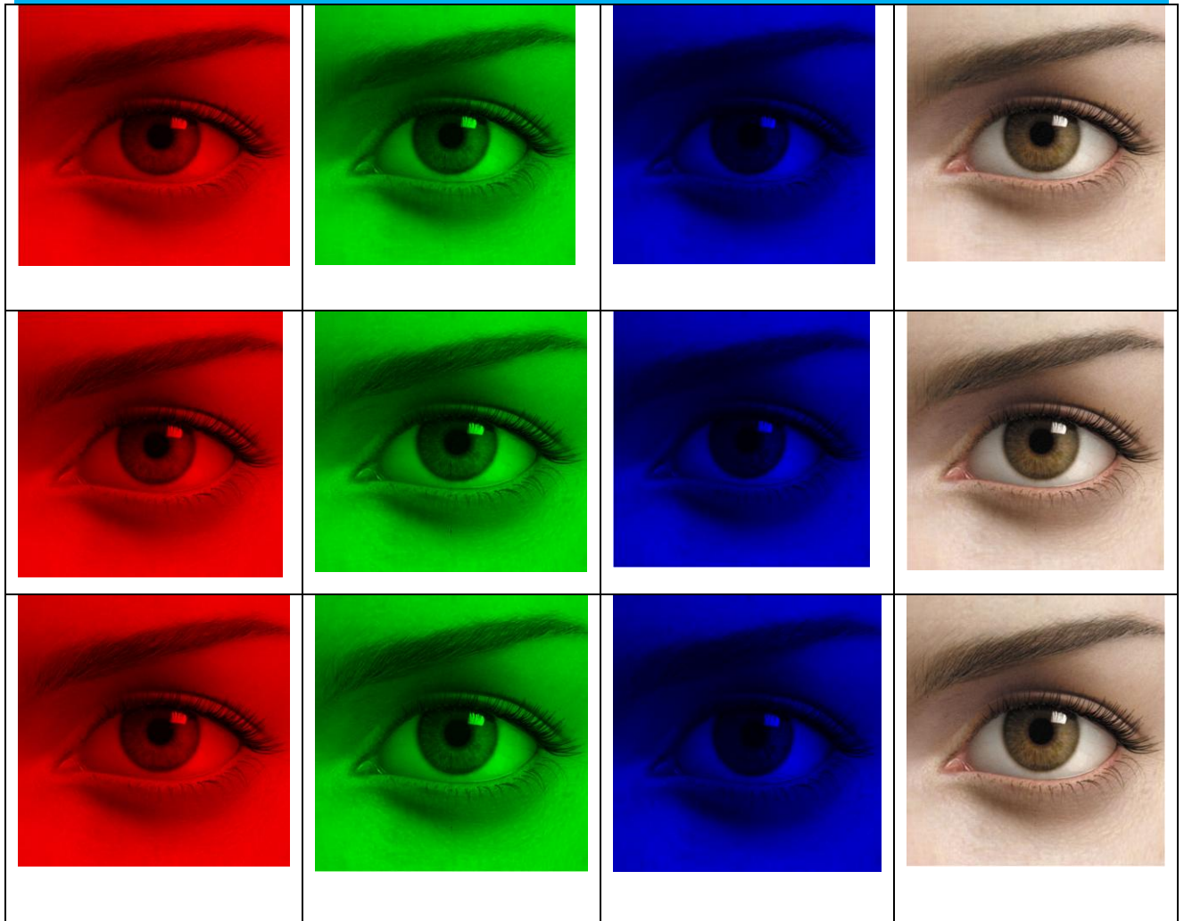
Figure III -7 montre une image de taille 2800x2052 divisée en trois images mises à l'échelle représentant les valeurs de pixels rouges, verts et bleus, puis effectuée le calcul SVD en utilisant les modes \{ \{25 ;50 ;75 ;100\} \} . (Mode=le nombre en valeurs singulières).
