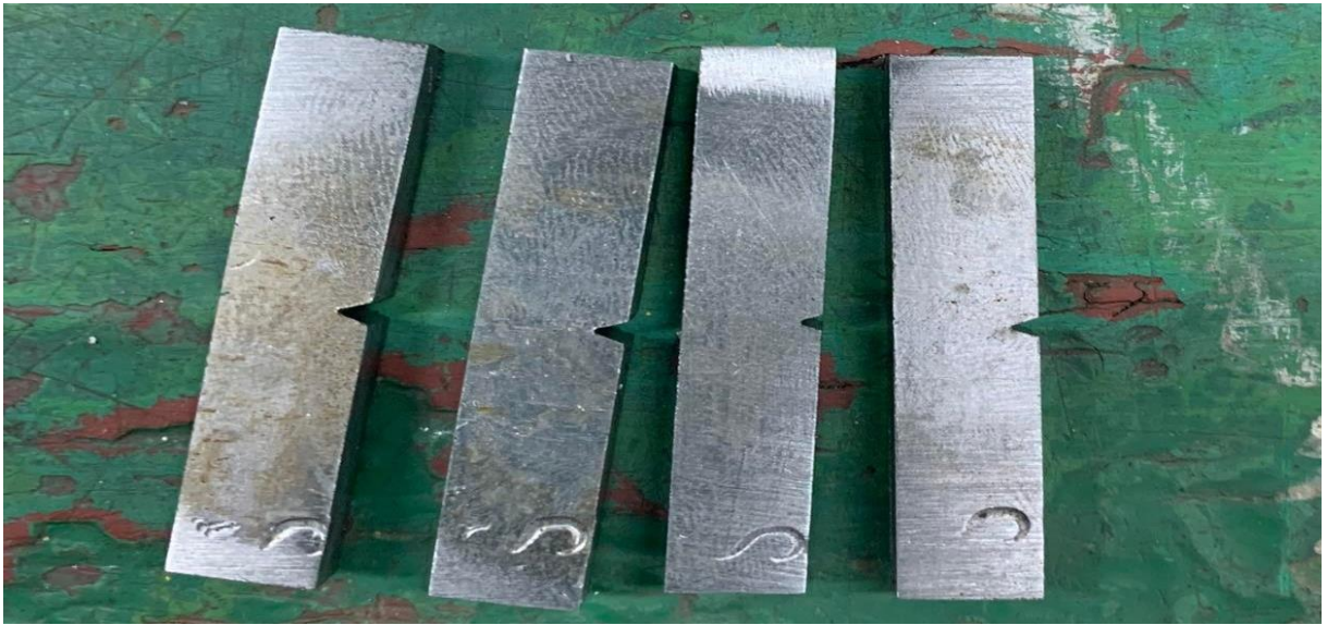
Figure II.4 les 4 pièces ne sont pas traitées.
