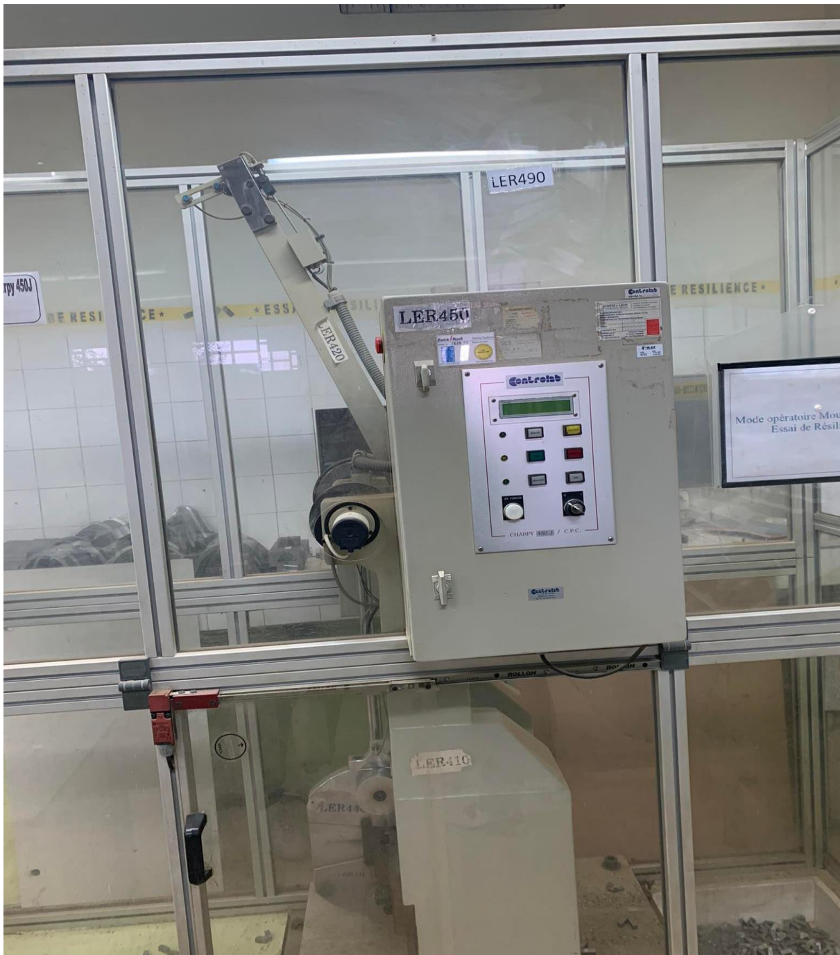
Figure II.15 Machine d'essai de résilience.
