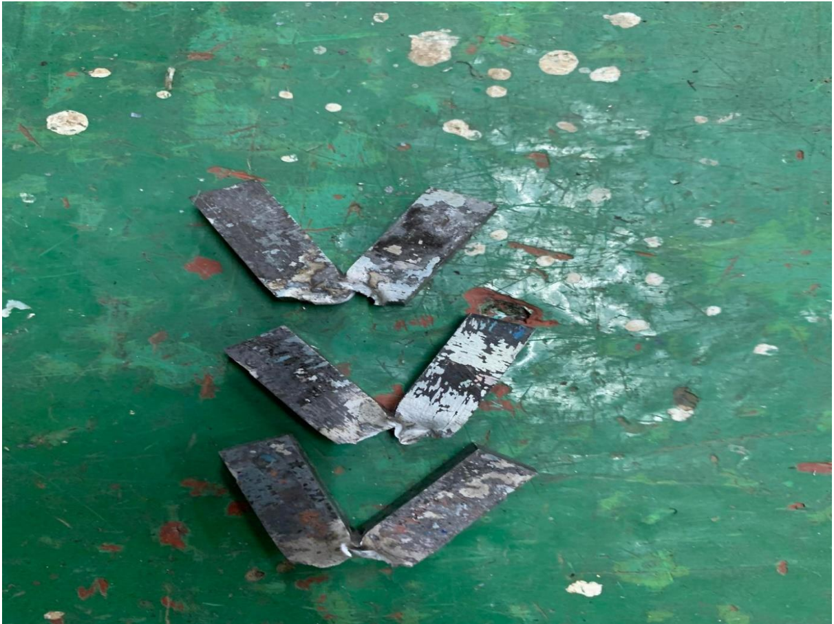
Figure II.17 les échantillons après résilience.
