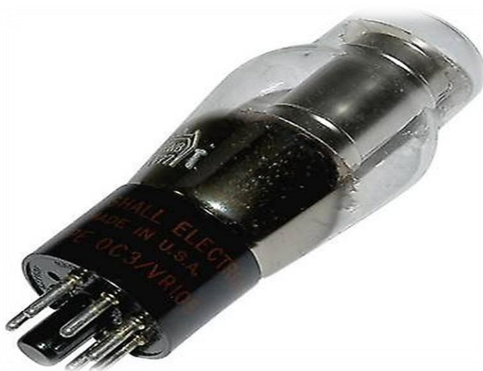
Figure 1.6. OC 3 = RV 105 Régulateur de tension à tube à vide 133 V.
