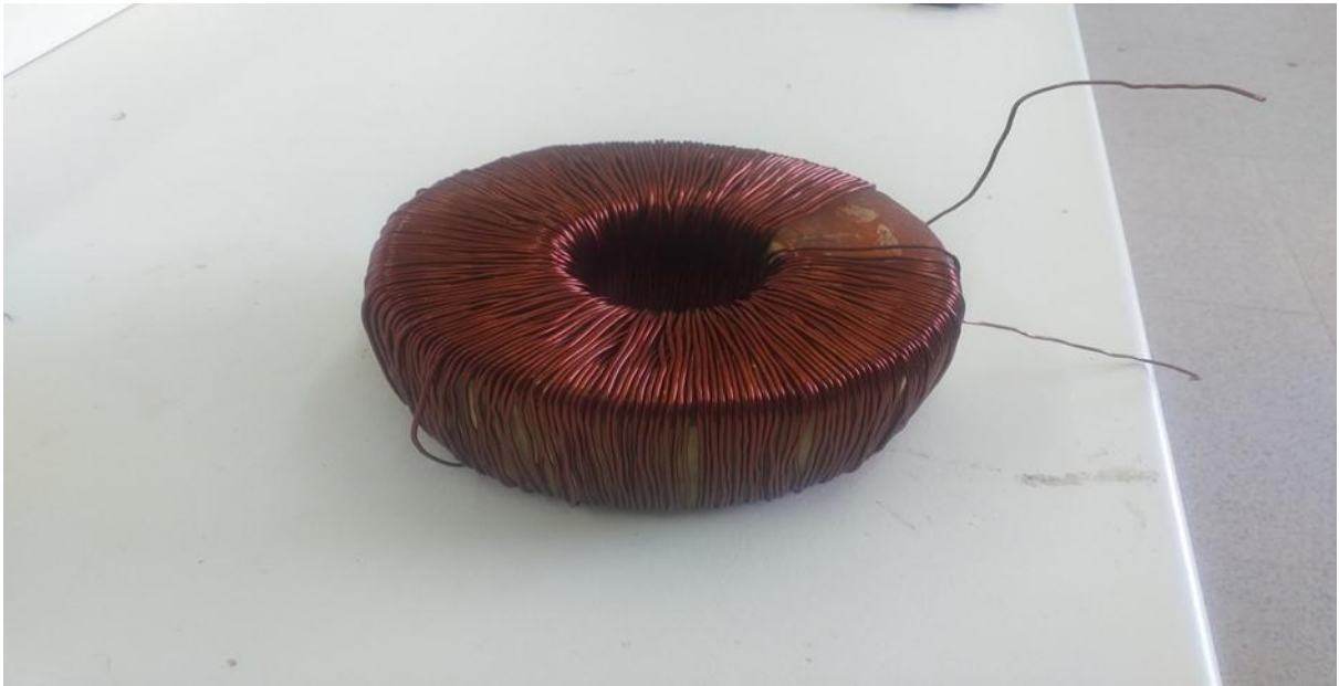
Figure 3.2. De vraies images des étapes d'enroulement du transformateur automatique manuellement.
