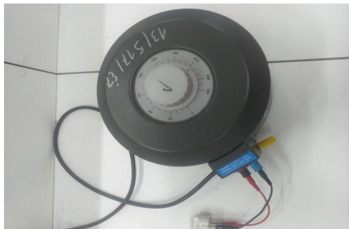
Figure 3.10. Transformateur de tension automatique.
