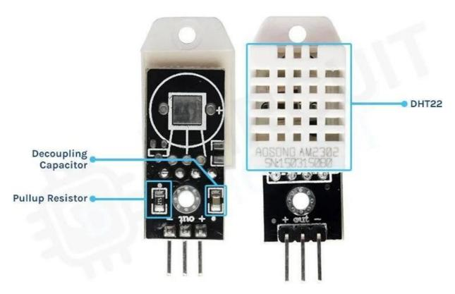
Figure III-4: DHT22 Sensor [23].
