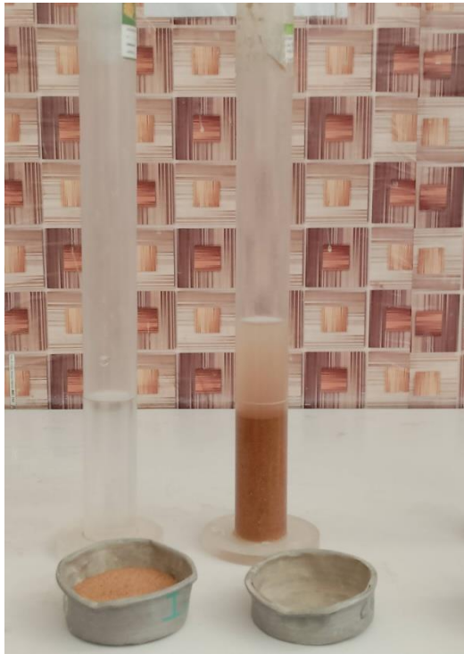
Image III.4: Essais de l'équivalent de sable. (Sourceauteur. 2024) Figure III.5: L'appareille pour l'essai l'équivalent de sable. (Mochten A, Ghdaier A.2023)
