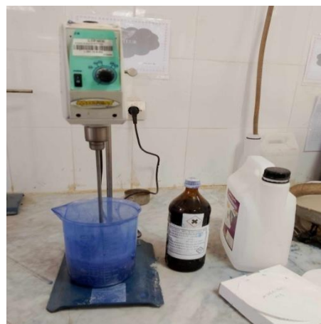
Image III.13: Essai bleu de méthylène. (Source auteur.2024)
