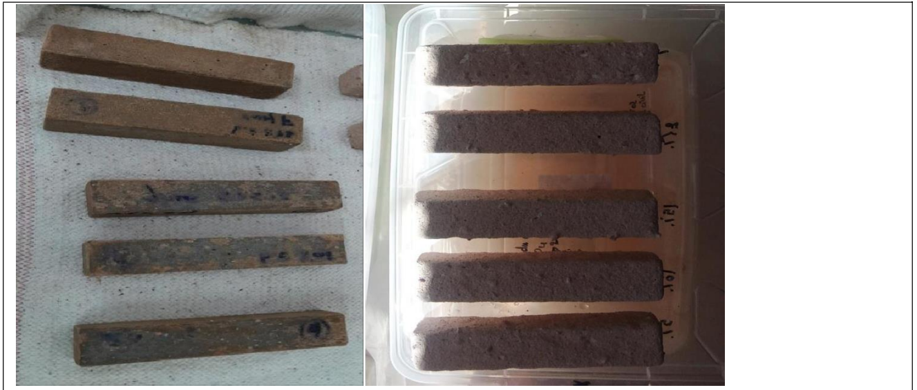
Image IV.15 : L'échantillon avant et après situer à la solution (Source auteur ,2024)
