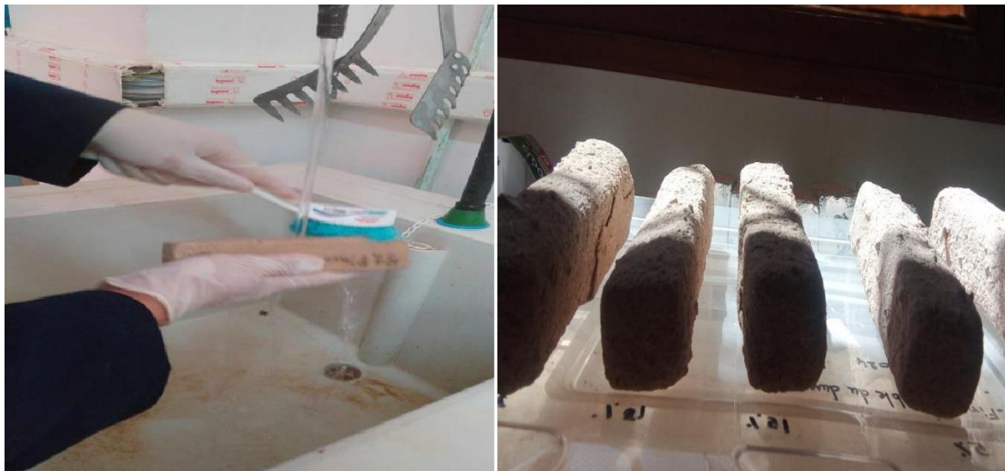
Image IV.13: Le nettoyage de l'échantillon (Source auteur ,2024) Image IV. 14: Les échantillons sont laissés à sécher (Source auteur ,2024)
