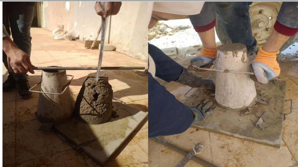
Image IV.5: Application de l'essai d'affaissement. (Source auteur, 2024)
