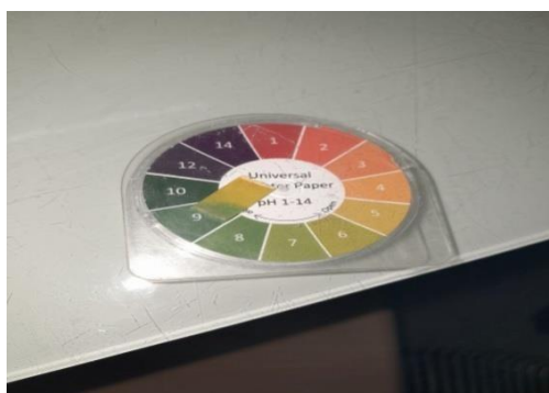
Image IV.12 : Bandelettes de papier indicateur le PH. (Source auteur, 2024)
