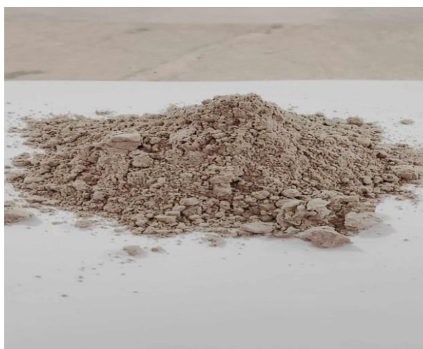
Image III. 9: Les fines de sable de la dune. (Source auteur, 2024)
