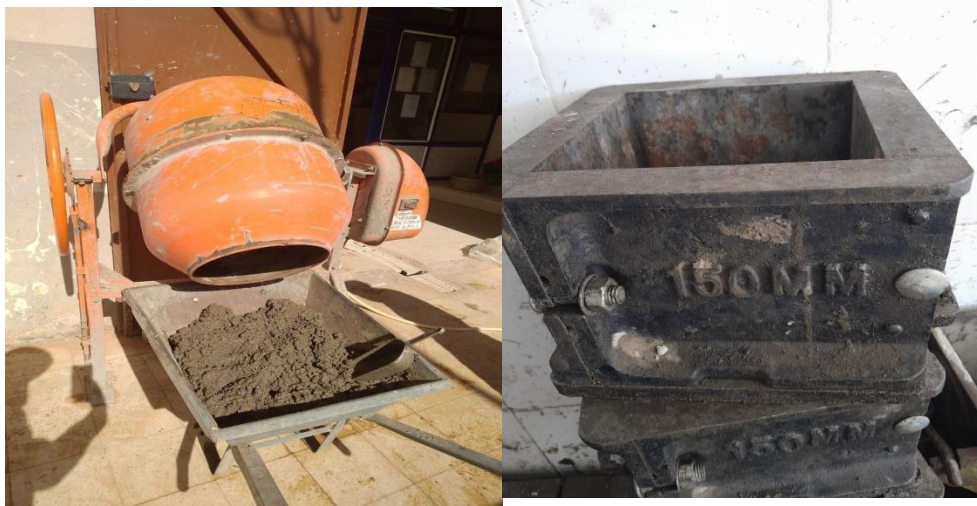
Image IV. 3: Malaxage. Image IV.4: Les moles d’éprouvette. (Source auteur, 2024)
