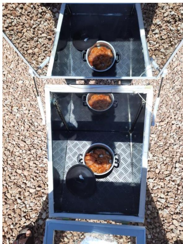
Figure II.10 – Résultats des tests de cuisson dans le cuiseur solaire optimisé.
