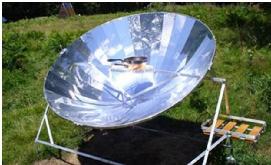
Figure I.4 – Cuiseur solaire de type parabolique.
