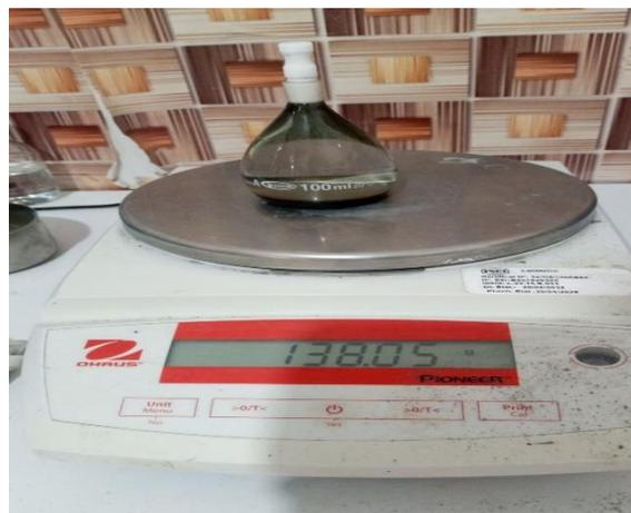
**Photo II.5.** Mesure de la masse volumique absolue de ciment. (Source : Auteurs)
