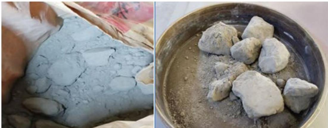
**Figure I.12.** Déchet de ciment préhydraté. (Source : [Zghair et al., 2025])
