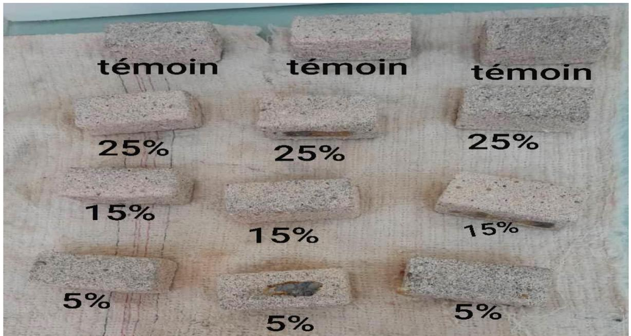
**Photo III.1.** Aspect visuel des mortiers après immersion dans l'acide. (Source : Auteurs)
