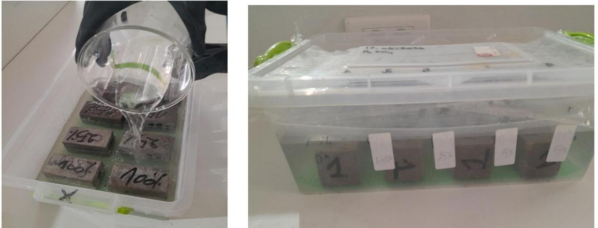
**Photo II.15.** Mesure de résistance à l'attaque acide. (Source : Auteurs)
