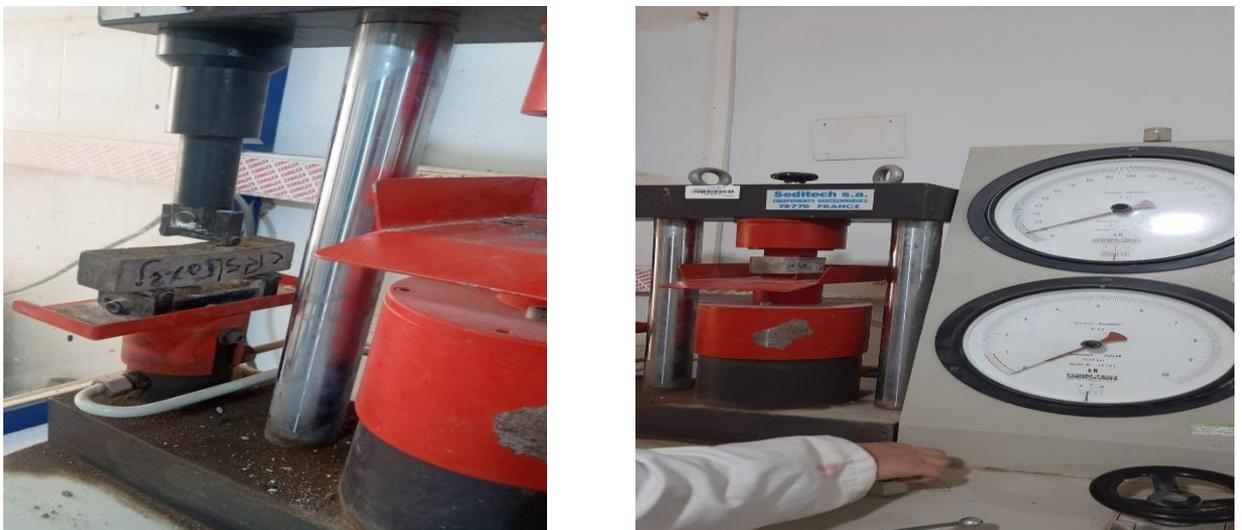
**Photo II.14.** Mesure de la résistance mécanique du mortier. (Source : Auteurs)
