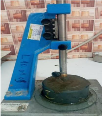
Photo II.12. Essai de prise de ciment.
