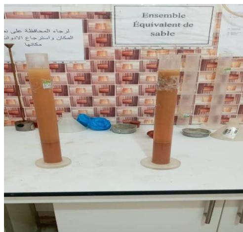
Photo II.10. Essai équivalent de sable. (Source : Auteurs)
