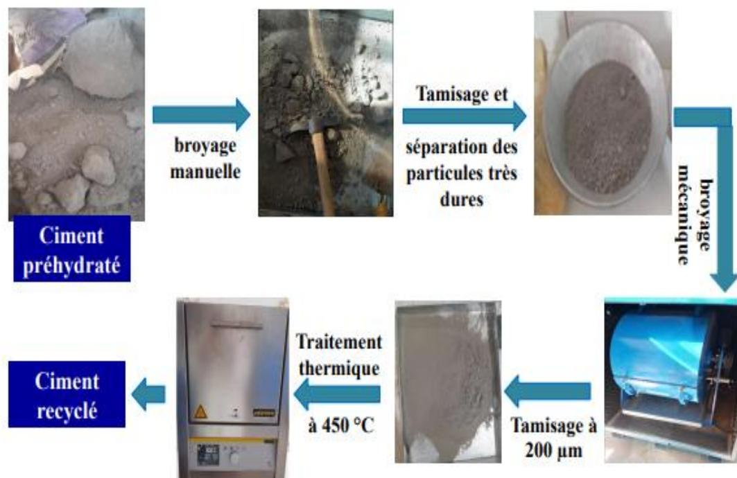
**Photo II.2.** Étapes de préparation de ciment recyclé. (Source : Auteurs)
