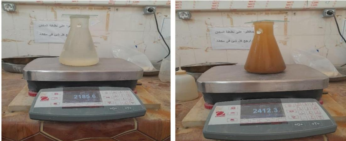
Photo II.9. Masse volumique absolue de sable. (Source : Auteurs)
