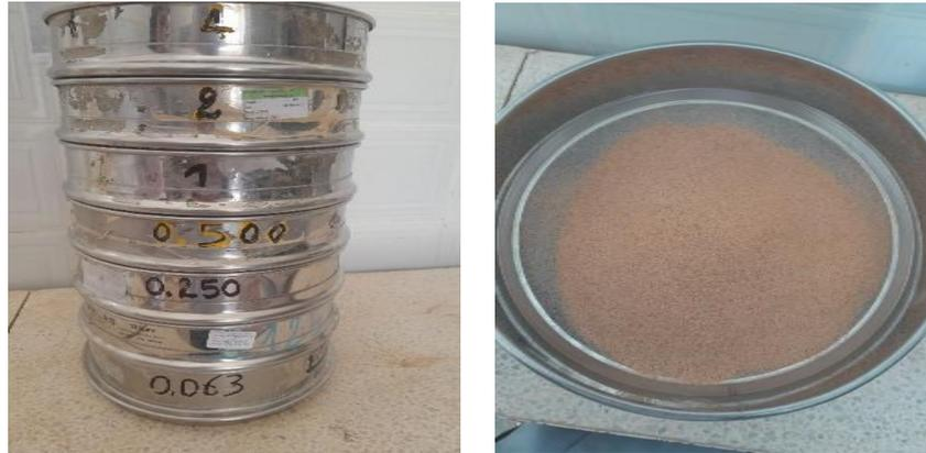
Photo II.7. Analyse granulométrique de sable. (Source : Auteurs)
