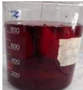
Immersion dans une solution de saccharose à 20 % pendant 15 min à une température ambiante.
