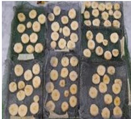
Après les prétraitements on place les tranches de banane dans des plateaux perforés
