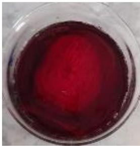
Immersion dans une solution d'acide citrique à 3% pendant 10 minutes à une température ambiante.
