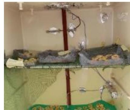
On place les pannées dans le séchoir solaire indirect sans stockage pour les sèches
