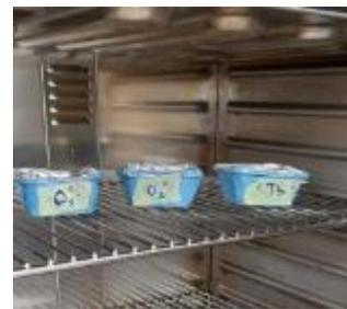
B. Les échantillons ont été insérés dans une étuve à une température de 105 °C pendant 24 heures.
