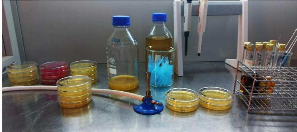
**Figure III. 21.** Matériel destiné à l'ensemencement aseptique sur gélose PDA de la flore fongique isolée à partir d'échantillons de produits séchés
