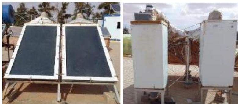
**Figure III. 15.** Séchoir indirect utilisé dans notre expériences.
