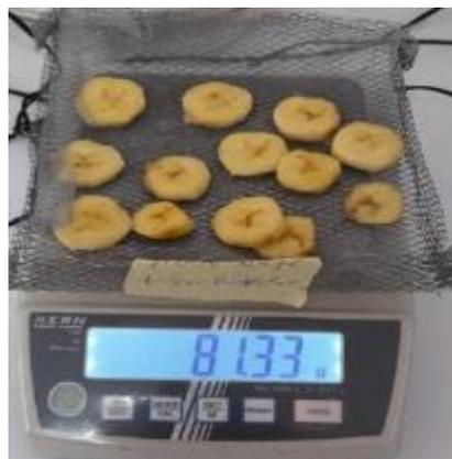
Enregistrement régulier de la masse des échantillons au cours du temps, mesure de la perte de masse à intervalles réguliers jusqu'à équilibre et calcul de la teneur en eau (X) en fonction du temps.
