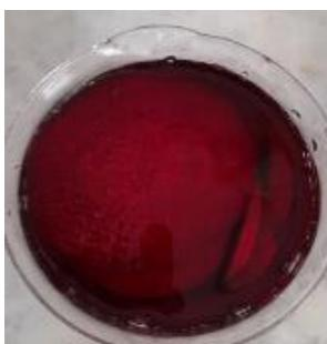
Immersion dans une solution de  $\text{CaCl}_2$  à 2% pendant 10 minutes à une température ambiante.
