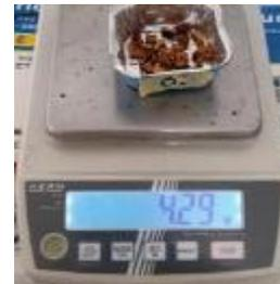
D. Le poids des échantillons a été mesuré ( $M_s$ ). Une fois les masses avant et après le séchage obtenu, la teneur en eau initiale est calculée en utilisant la relation (III.1).
