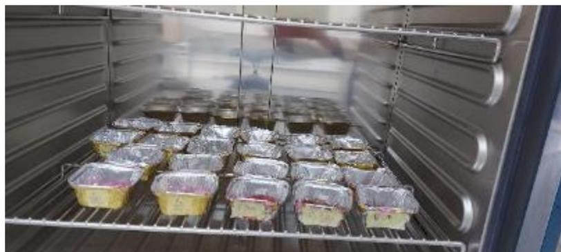
**Figure Annexe 14 :** Illustration de Manipulation pour calculer teneur en humidité (humidité résiduelle).
