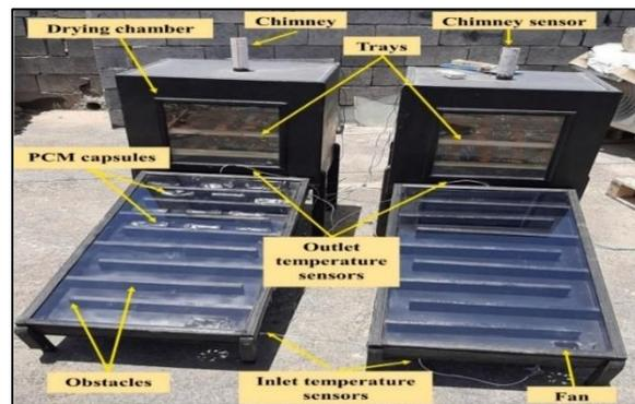
Figure II.34 Séchoirs solaires expérimentaux[42].
