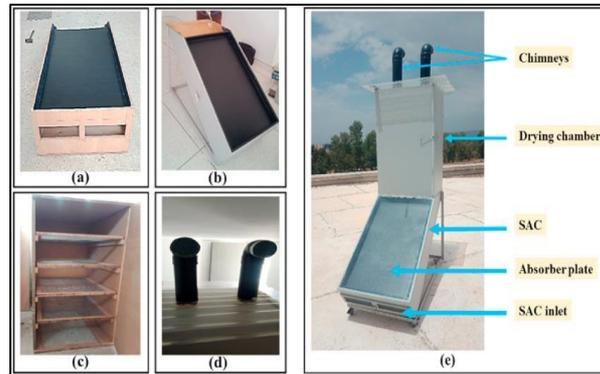
**Figure II.29** Dispositif expérimental ; (a), (b) Capteur solaire, (c) Chambre de séchage, (d) Cheminées, (e) Montage expérimental [37].
