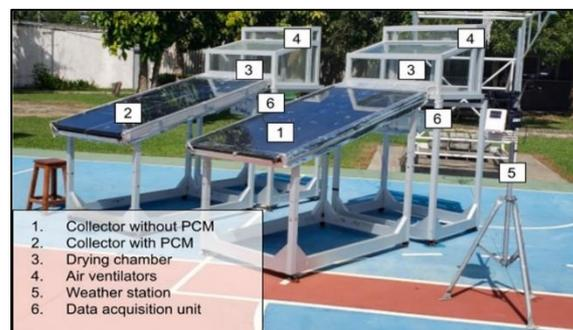
**Figure II.22** Vue générale de l'installation expérimentale [31].
