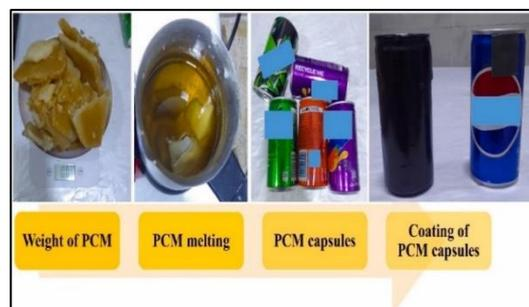
Figure II.35 Fabrication des boîtes de PCM [42].
