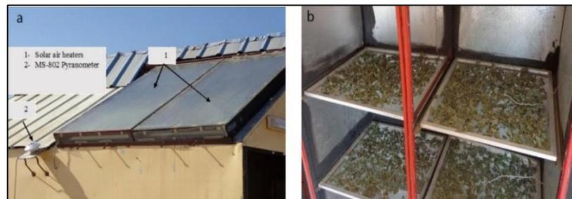
**Figure II.11** (a) Photographie des unités de séchage solaire et des capteurs solaires, (b) intérieur de la chambre de séchage. [23]
