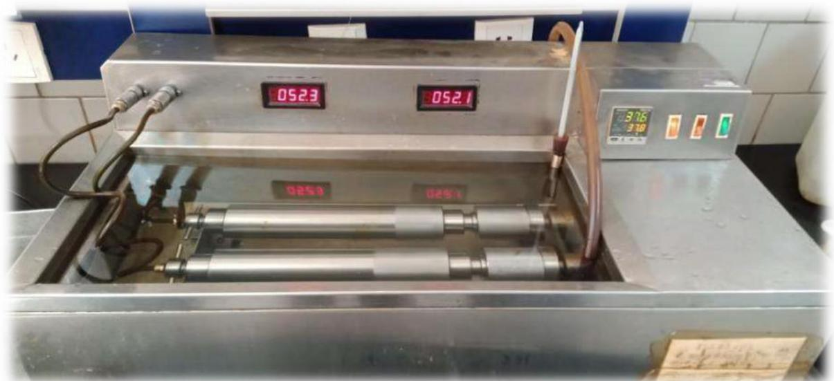
Figure II.09 : Appareil de la mesure de Tension de Vapeur Reid (TVR)
