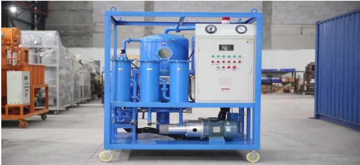
**Figure IV.1:** Machine de filtration d'huile de transformateur sous vide poussé.
