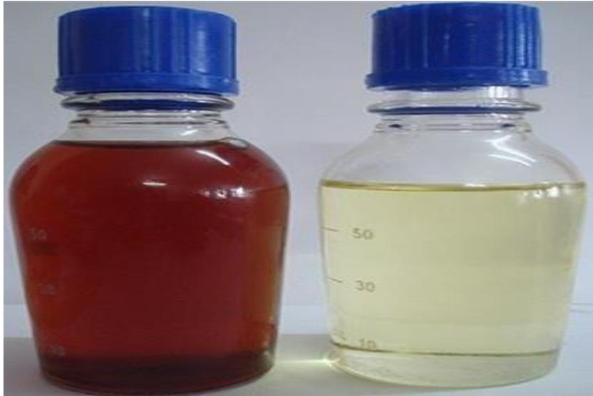
**Figure IV.3:** Huile de transformateur avant et après filtration.
