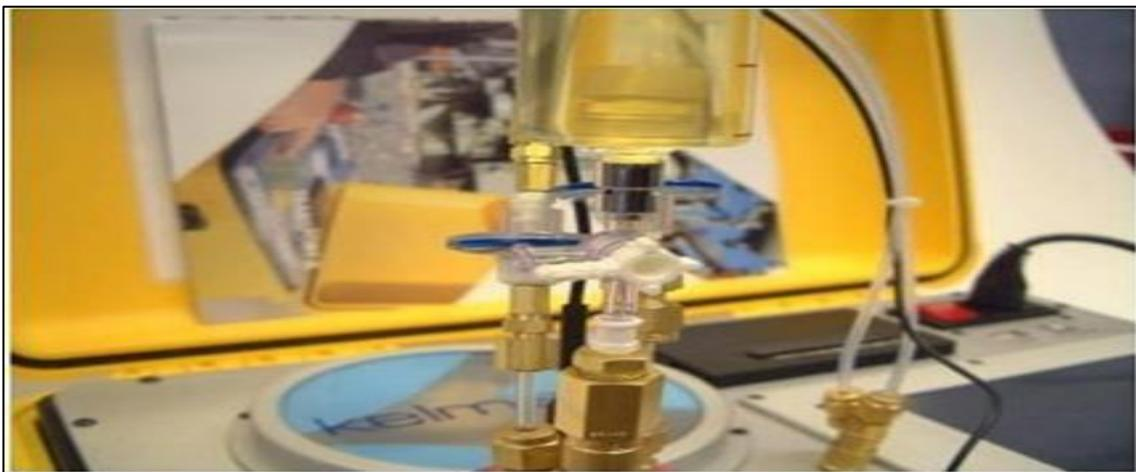
**Figure III.15:** Robinet d'arrêt (vanne à trois voies) avec bras latéral fermé.
