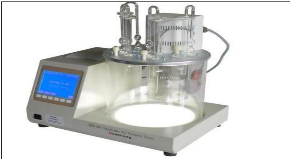
**Figure III.3:** Appareil de mesure de la viscosité.
