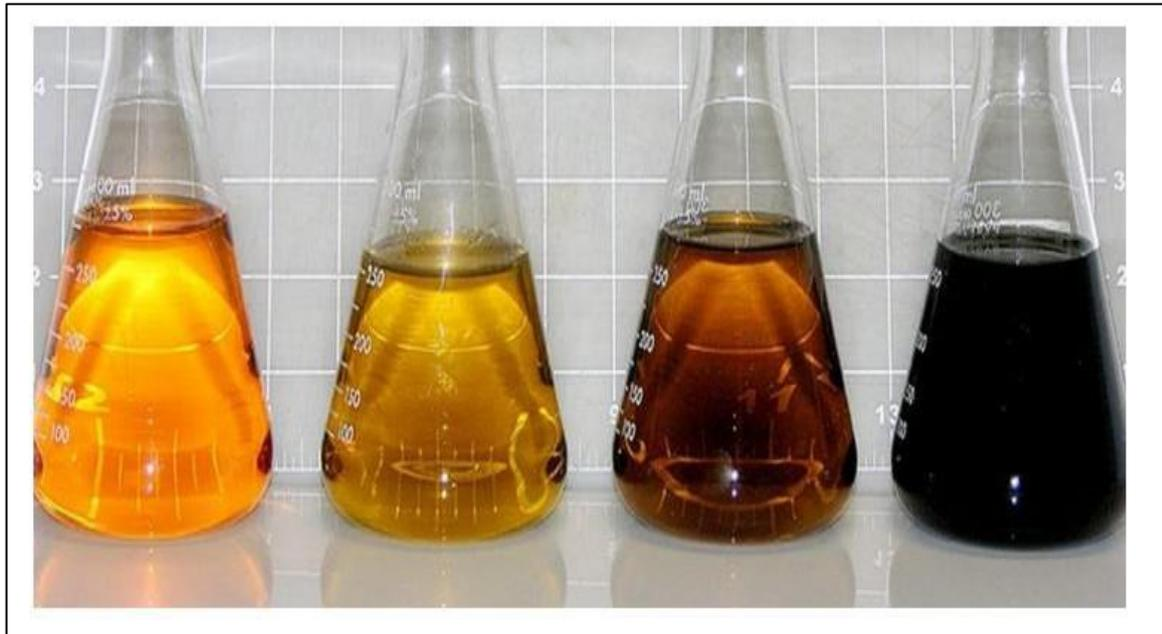
**Figure III.5:** Dégradation de liquide isolant au cours de vieillissement thermique (changement de couleur).
