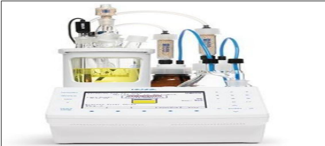
**Figure III.1:** Titreur coulométrie karl fisher pour la mesure de la teneur en eau de liquide isolant.
