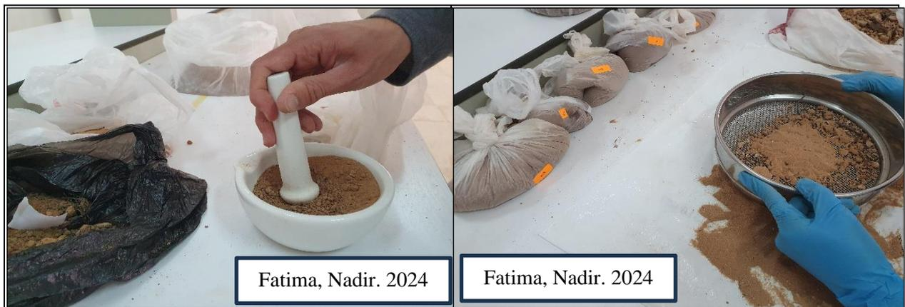
**Figure 8 :** Tamisage et broyage des échantillons au niveau de laboratoire.
