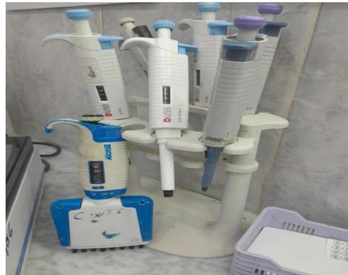
Micropipette monocanal et multicanaux.
