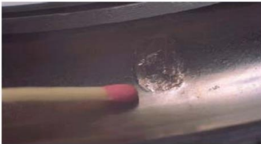
Figure IV.22: Bague externe défailante [35]
