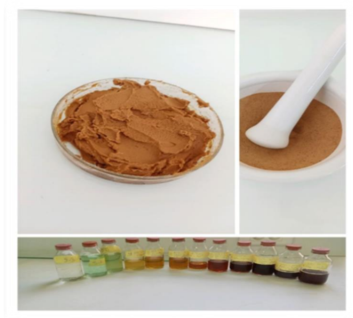
Figure III. 6 : étape d'enrobage et l'extrait de méthanol par le VLC
