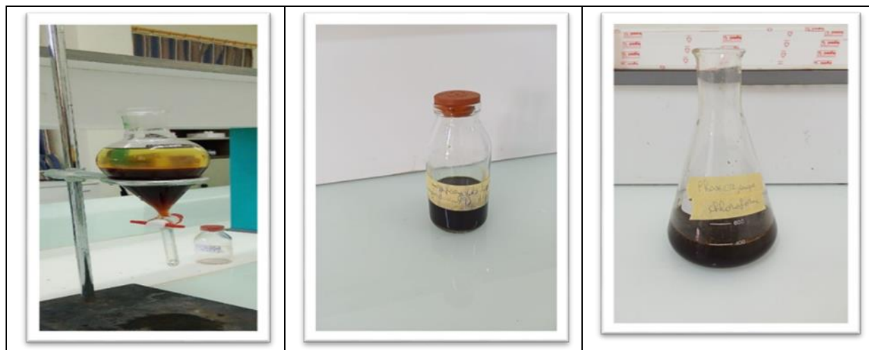
Figure III.3 : une extraction liquide/liquide de chloroforme
