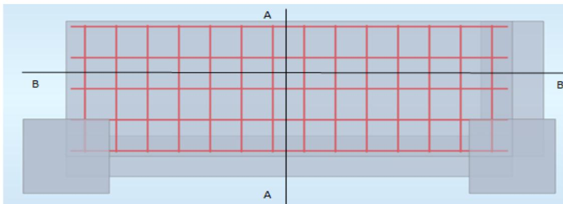
Figure III.13 : Schémas de ferrailage du balcon en 2D.
