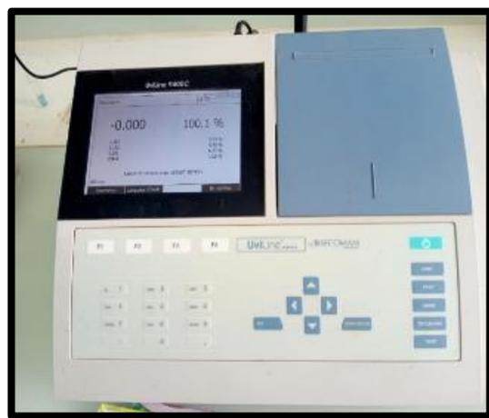
Figure 13 : Spectrophotomètre UV-Vis
