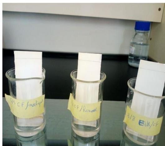
Figure 20 : Préparation de plaques CCM utilisant des différentes phases mobiles pour séparer les composants de l'échantillon
