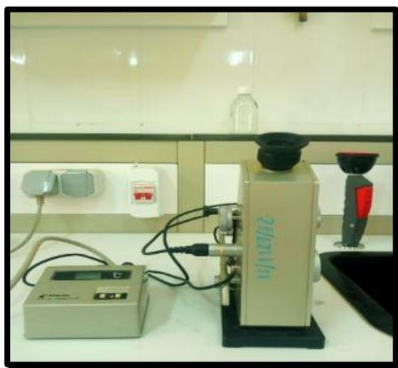
Figure 15 : Détermination de ° Brix par un réfractomètre.
