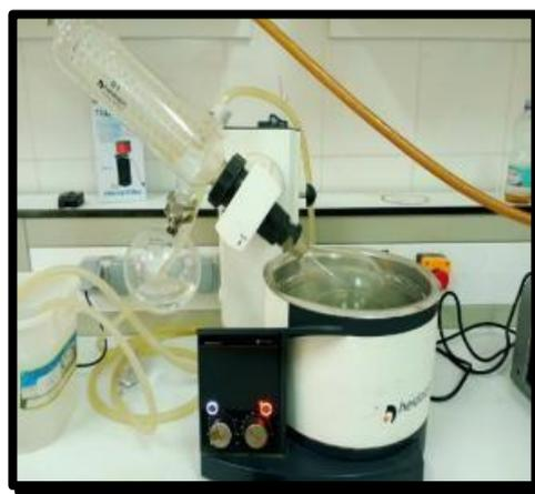
Figure 17 : Elimination de solvant du ballon par évaporation à vide.
