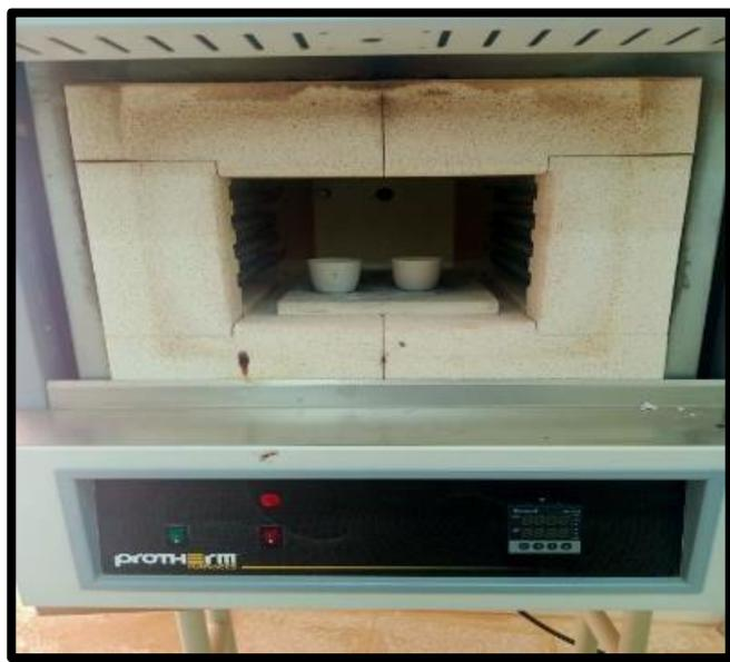
**Figure 11 : La détermination de la teneur en cendres dans un four à moufle.**
