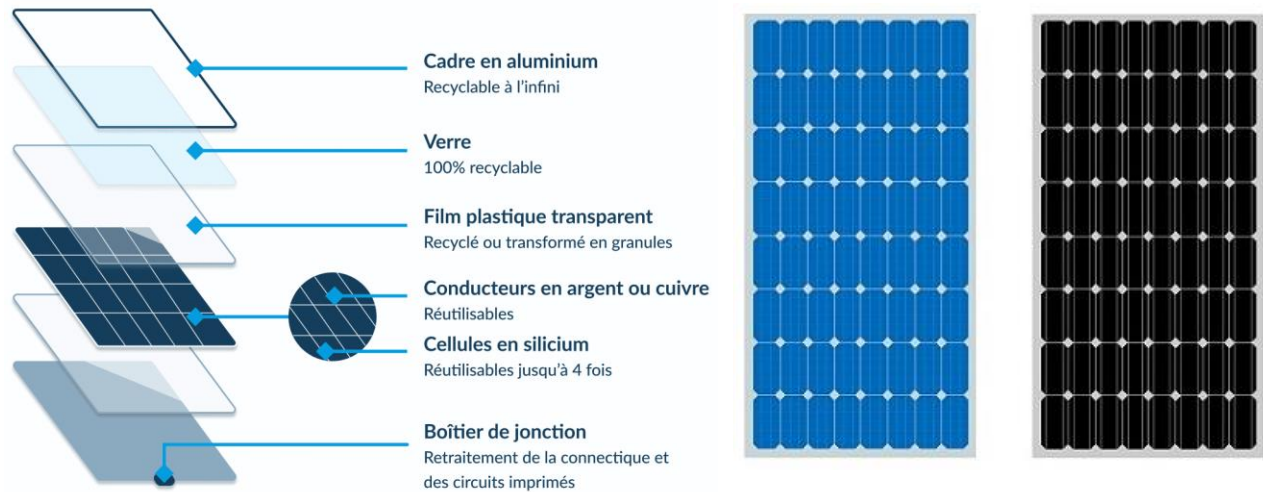
Figure 1.1 : Schéma descriptif et composition d'un panneau solaire [5]
