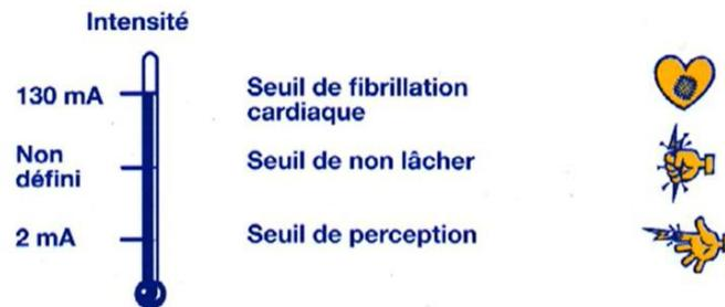
Figure 2-1: Effets respiratoires et circulatoires du courant électrique (AC/DC)
