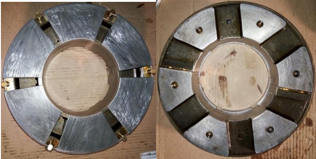
Figure 1-10 Palier de butée
