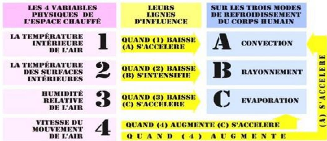
Figure. II. 5: Relations entre les paramètres de confort et les modes d'échange de chaleur .
