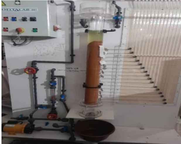
Figure II. 6: Filtration à sable sur une hauteur de 80cm
