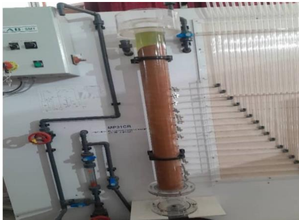
Figure II.7 : Filtration à sable sur une hauteur de 100cm
