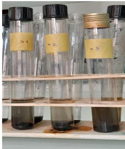
**Photo (IV.6) :** Préparation des mélanges (coke + mélange de solvants)
