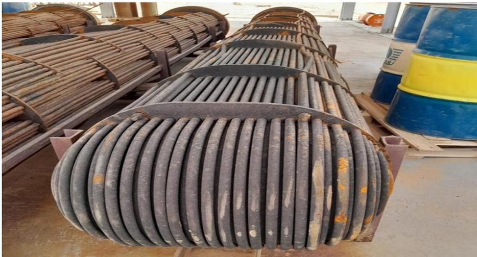
**Photo (III.4) :** Etat réel de l'encrassement de l'échangeur à tubes et calandre à l'unité GPL-2
