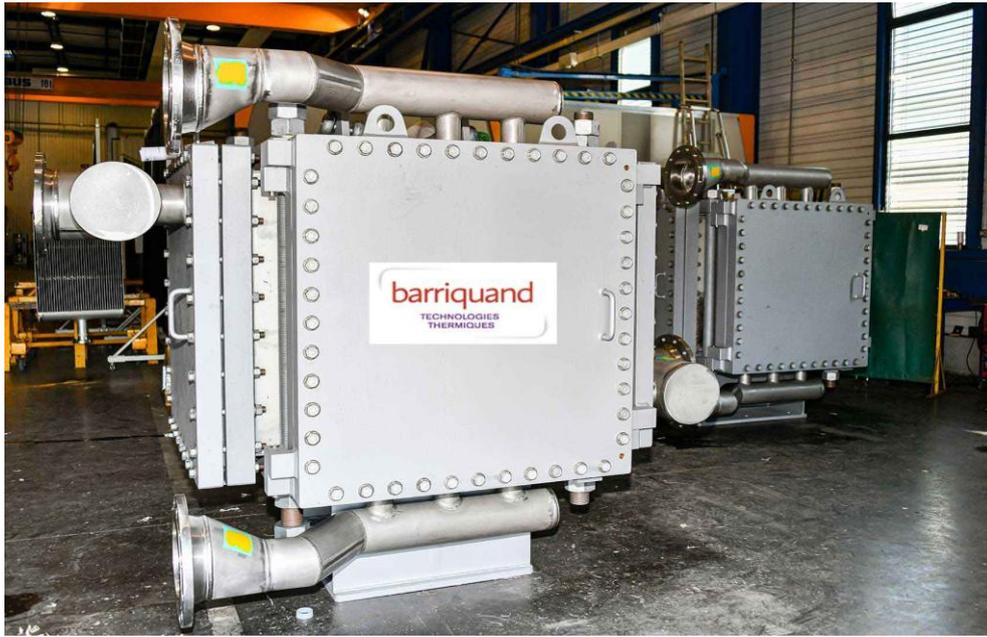
**Figure (III.12) :** Echangeur à plaques tout soudé [26]
