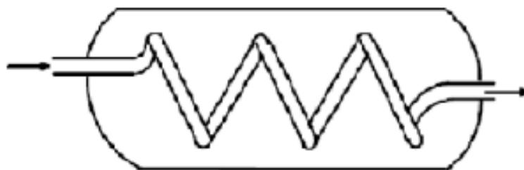
Figure (III.4) : Echangeur monotube [25]
