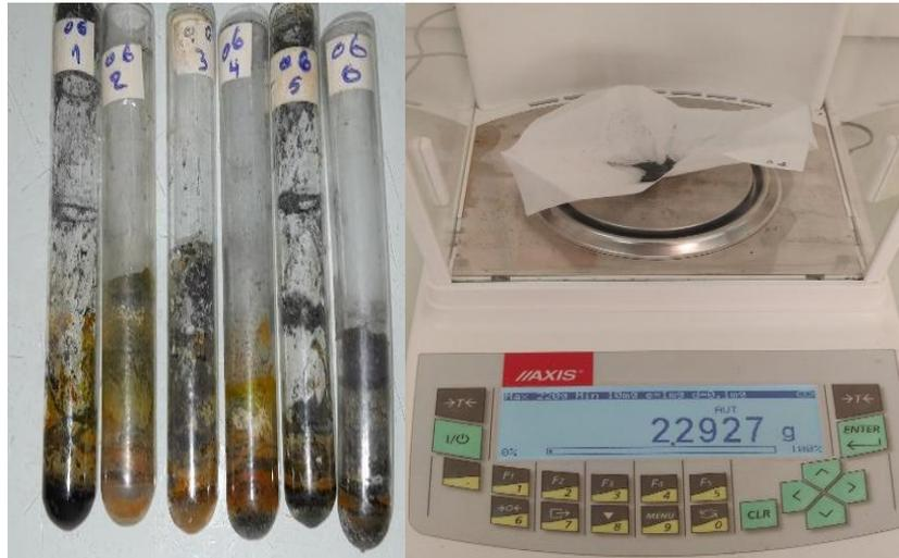
**Photo (IV.3) : Séchage et la pesée de l'échantillon**
