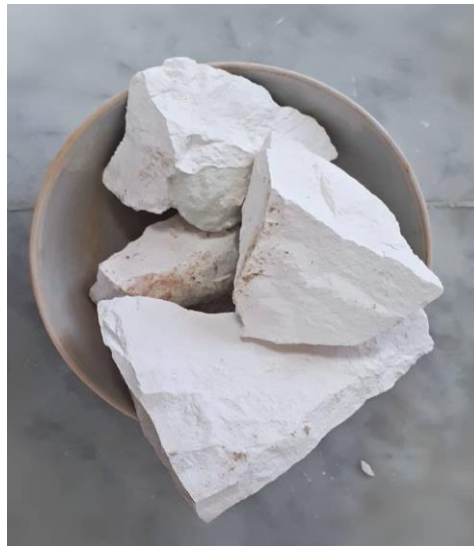
Figure 56 : Obtention de chaux après une température de 900°C degrés, [Les auteurs]
