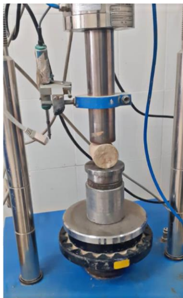
Figure 50 : Essai de résistance en traction par fendage: dispositif expérimental, développement de la fissuration sous chargement, [Les auteurs]
