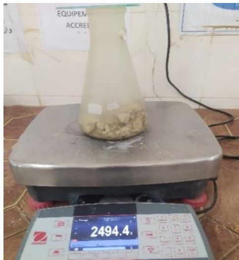
Figure 48 : essais de la masse volumique absolue, [Les auteurs]
