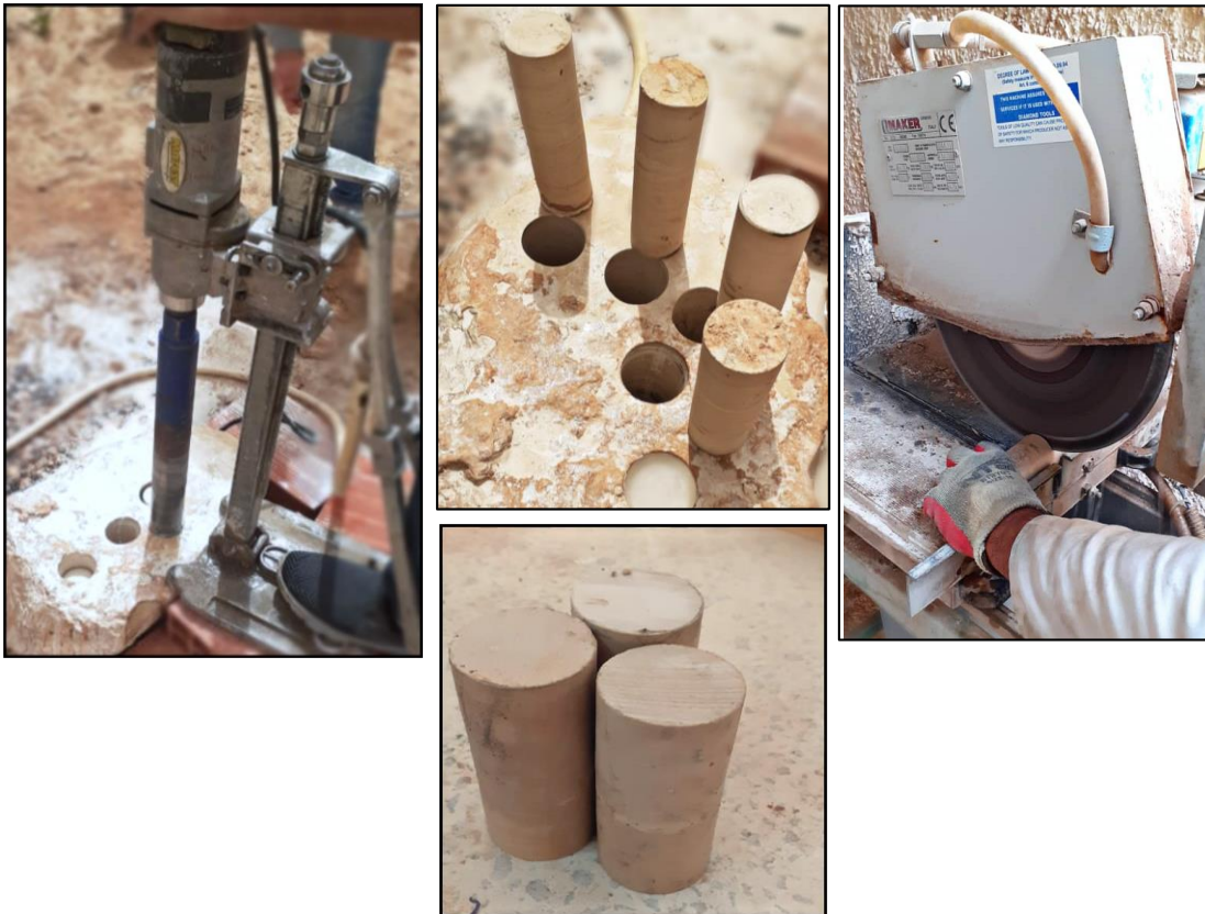
Figure 47 : Préparation des échantillons, [Les auteurs]
