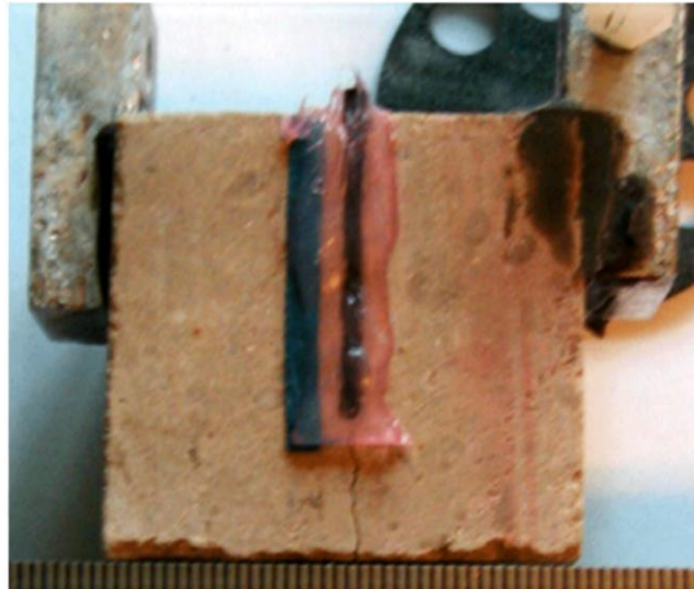
Figure 40 : Eprouvette de Larrys perlé après rupture (24)
