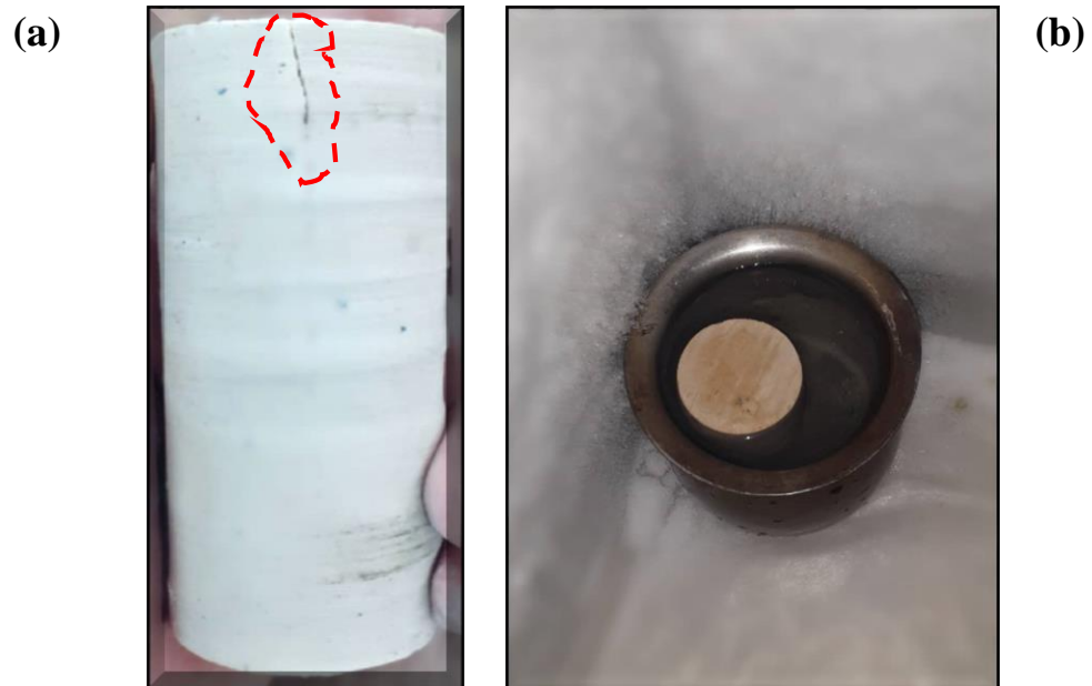
Figure 58 : (a) L'échantillon est dans un milieu aqueux à l'intérieur du refroidisseur, (b) Evolution de l'état visuel d'endommagement des échantillons après 30 cycles de gel-dégel, [Les auteurs]
