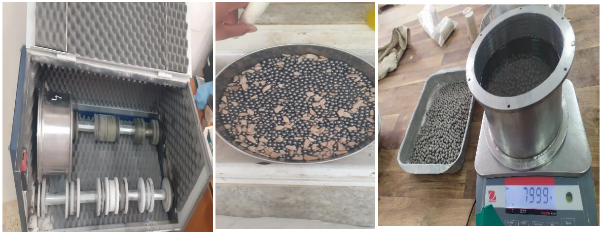
Figure 52 : Essai La résistance à l'usure par essai Micro-Deval : dispositif expérimental, Articles de moins de 1,6 mm à l'aide d'un tamis, [Les auteurs]
