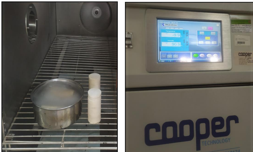
Figure 55 : La chambre froide utilisée est à - 10°C, les échantillons sont à l'intérieur de la chambre froide, [Les auteurs]
