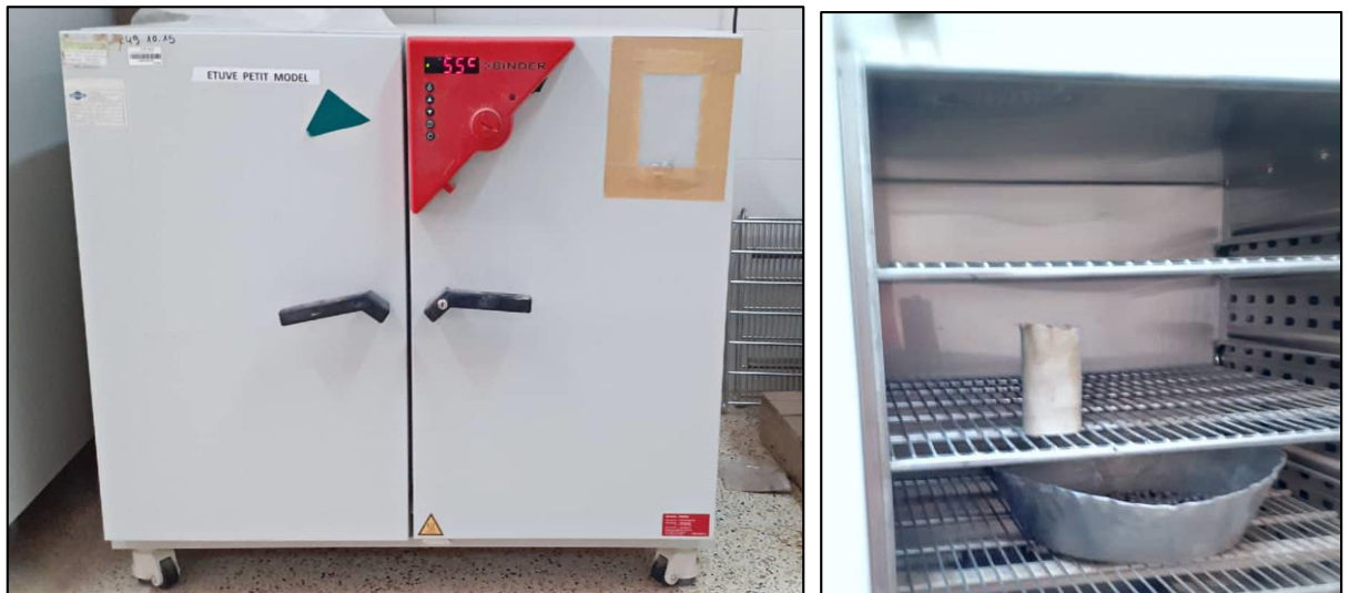
Figure 54 : Le four utilisé est 55 °C, l'échantillon est à l'intérieur du four, [Les auteurs]
