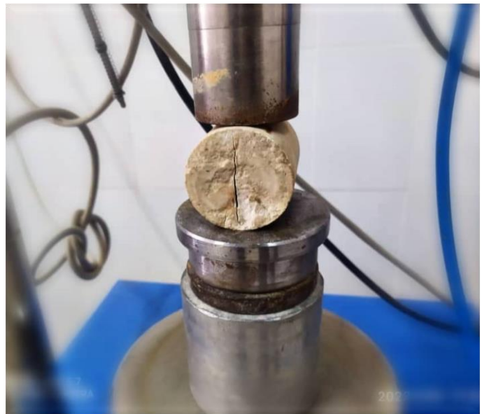
Figure 50 : Essai de résistance en traction par fendage: dispositif expérimental, développement de la fissuration sous chargement, [Les auteurs]
