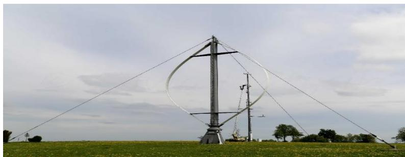
Figure (I.12) : Darrieus de 5[méter] de diamètre [14]
