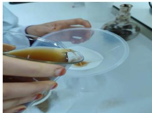
**Figure 5 :** Filtration des solutions après extraction. (Originale)
