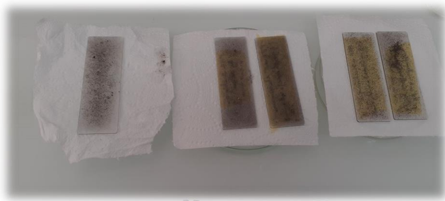
Figure II.10 : Revêtement de nanocomposite (CuONPs chimique) avec trois proportions différentes.
