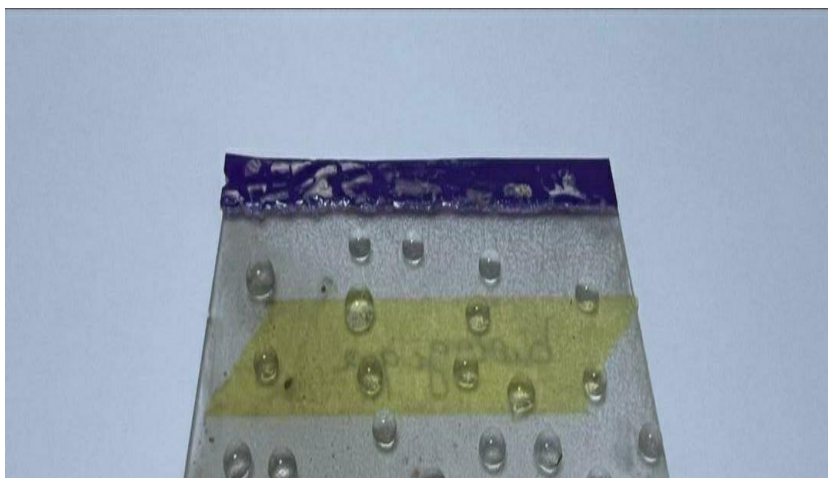
Figure III.9 : Image montrant la forme des gouttes d'eau sur la surface du revêtement avec la Méthode des gouttes.
