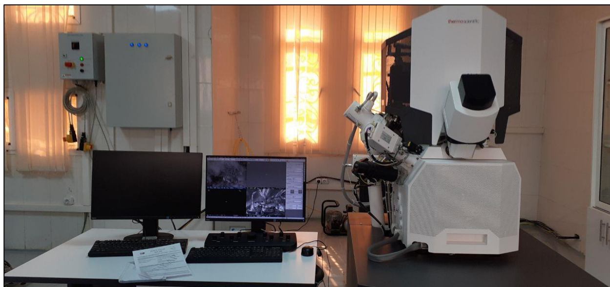
Figure II.15 : Appareille de MEB couplé à l'EDX «SU3500».
