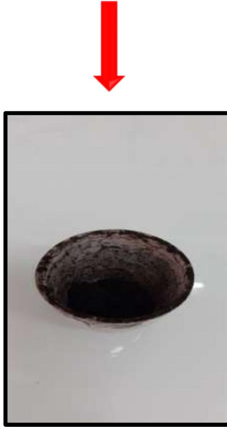
**Figure II.9 :** nanoparticules d'oxyde de cuivre (CuNPs).
