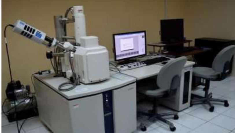
**Figure II.13:** Appareil de MEB couplé à l'EDX «SU3500 ».
