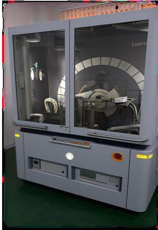
**Figure II.11** : diffractomètre de modèle Malvern Panalytical.
