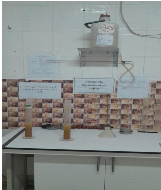
Figure III.2 : Essai de l'équivalent de sable [Laboratoire LTPS (Ghardaïa)].
