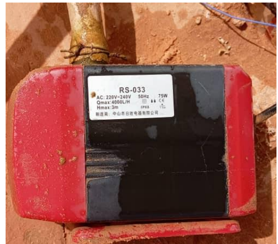
Fig 22 : Pompe à eau
