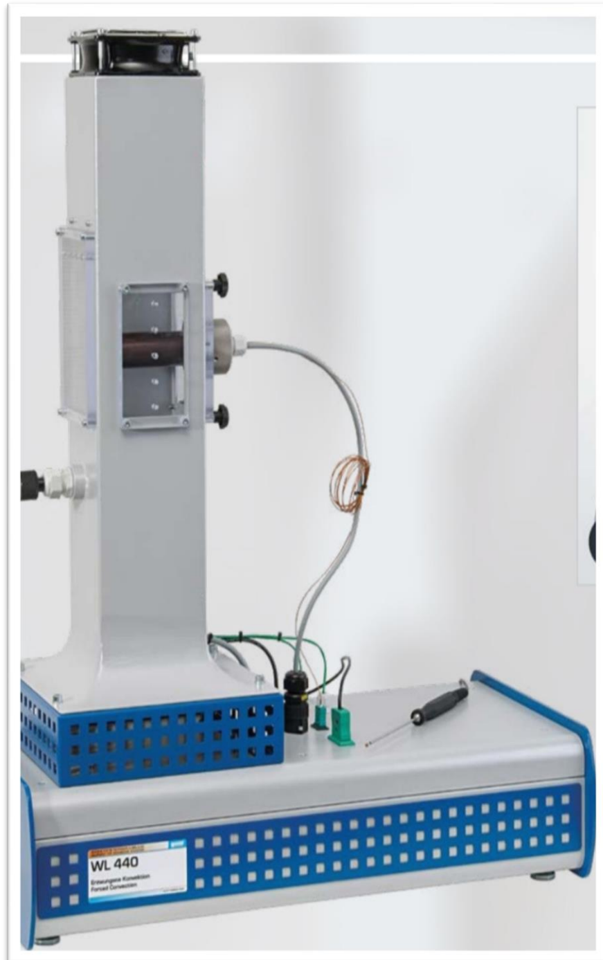
Figure. II.8. Représente l'appareil de la convection mixte de type WL 440
