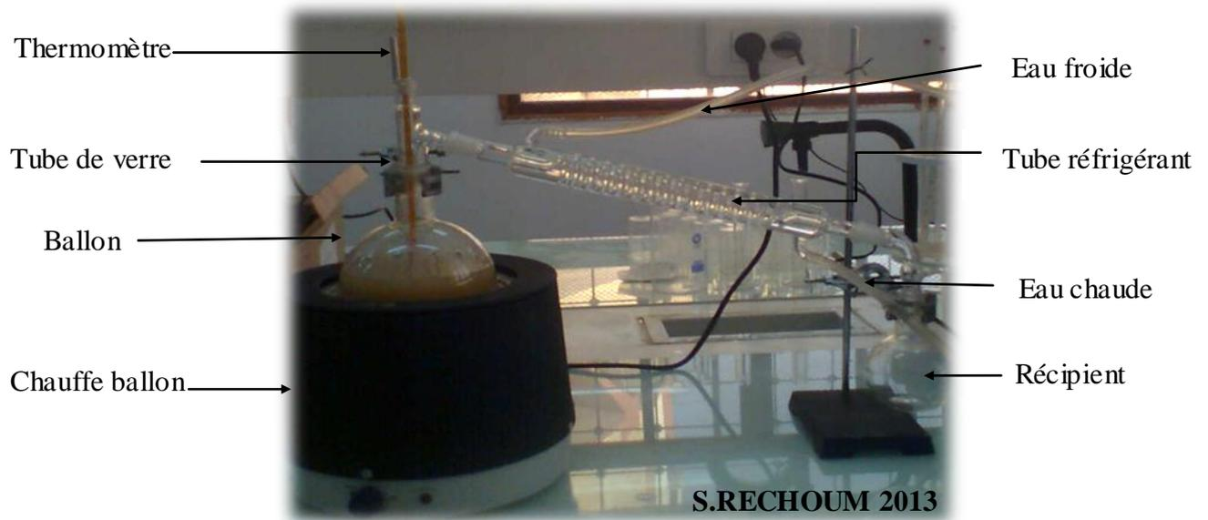
**Photo 09** : dispositif de la distillation
