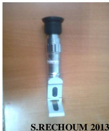
**Photo 14** : réfractomètre de brix de (0-80 %)
