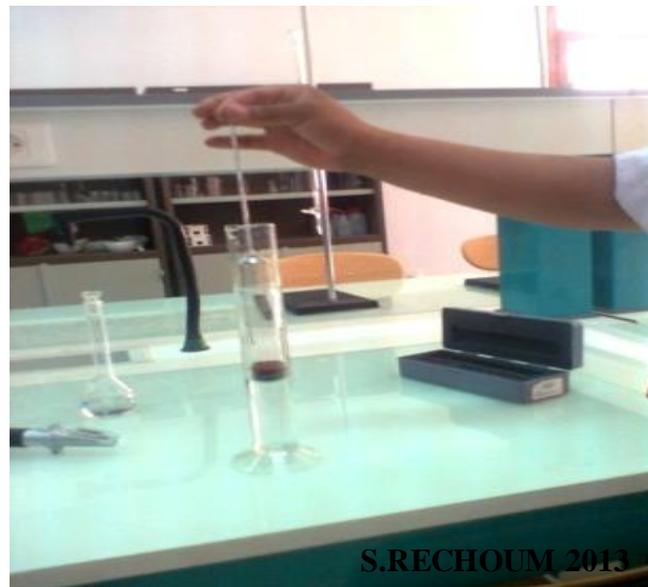
**Photo 13:** le test à alcoomètre
