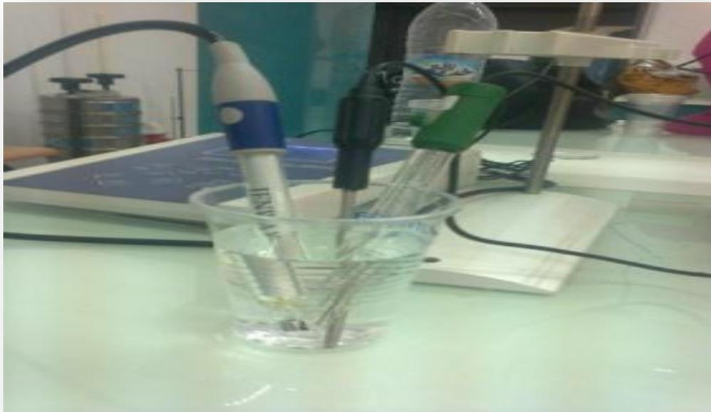
**Figure 31 : mesure de PH, conductivité ,salinité**
