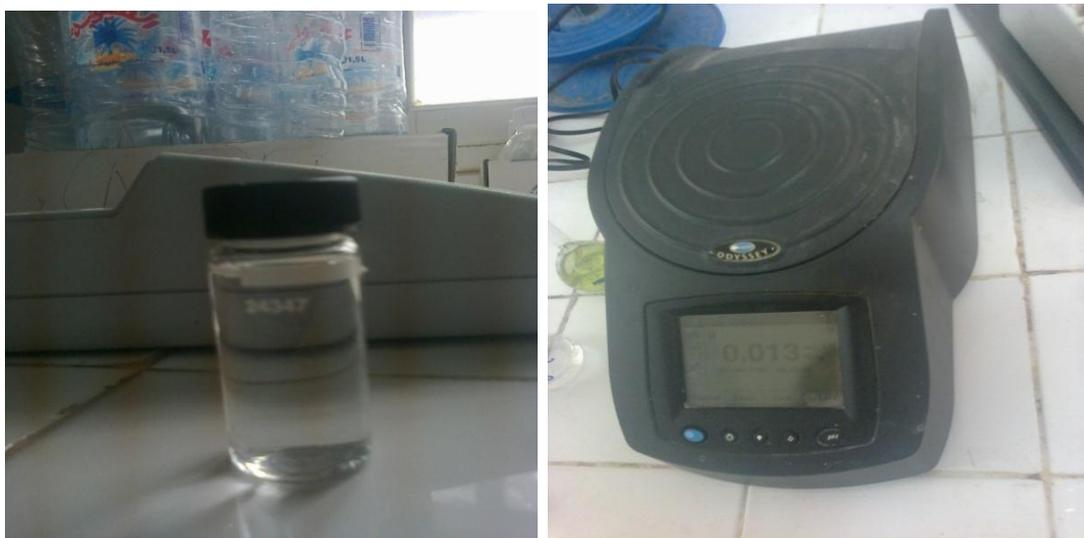
**Figure 39 : mesure de ortho phosphate**
