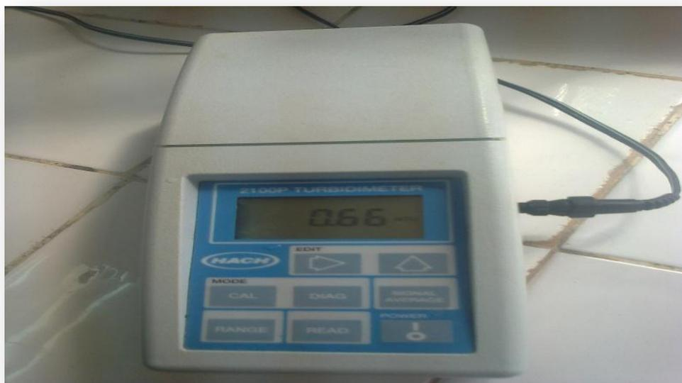
Figure 16 : (turbidimètre)
